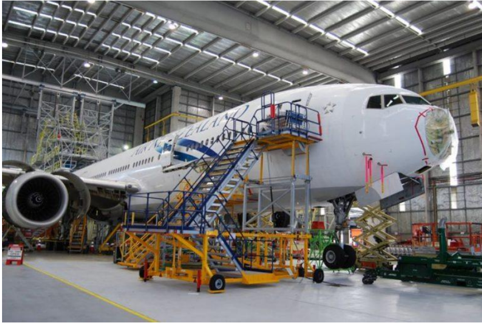
Şekil 3.2: Hangarda uçak kapısına ulaşmak için kullanılan merdiven platform [13]
