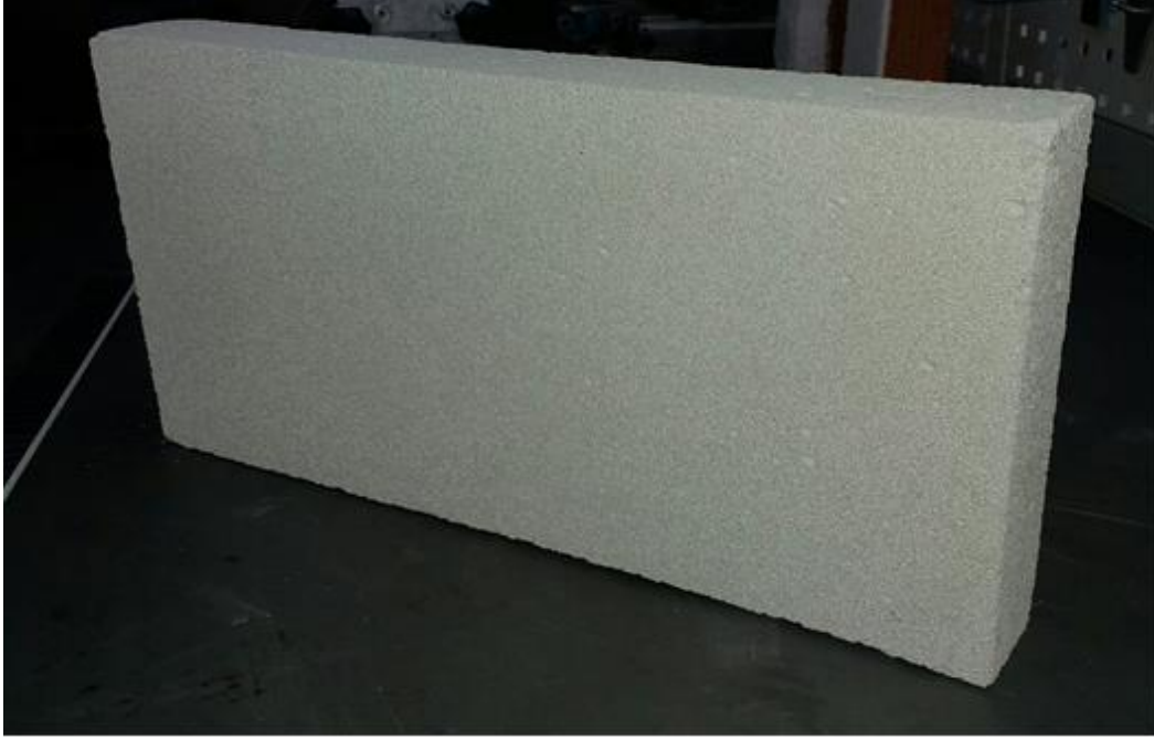
Şekil 3.3 : Yekpare harç katmanlı plaka örneđi.
