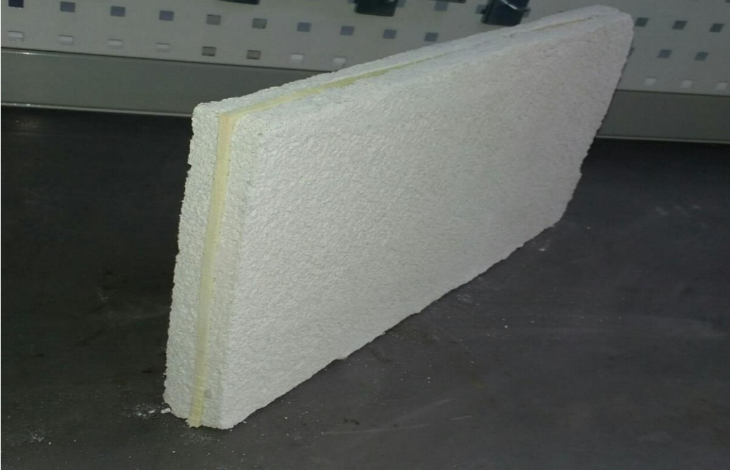
Şekil 3.4 : İki harç arasına suni kauçuk plaka yerleřtirilmesiyle oluřan kompozit plaka örneđi.
