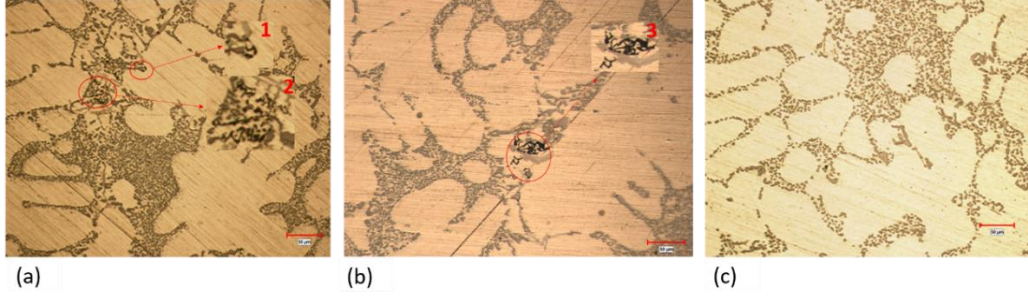
Şekil 1.6: A356 alaşımının (a), (b) ısıtıl işlemsiz ve (c) ısıtıl işlemlili mikroyapıları. 1, 2, 3: Mg 2 Si intermetalik bileşikleri
