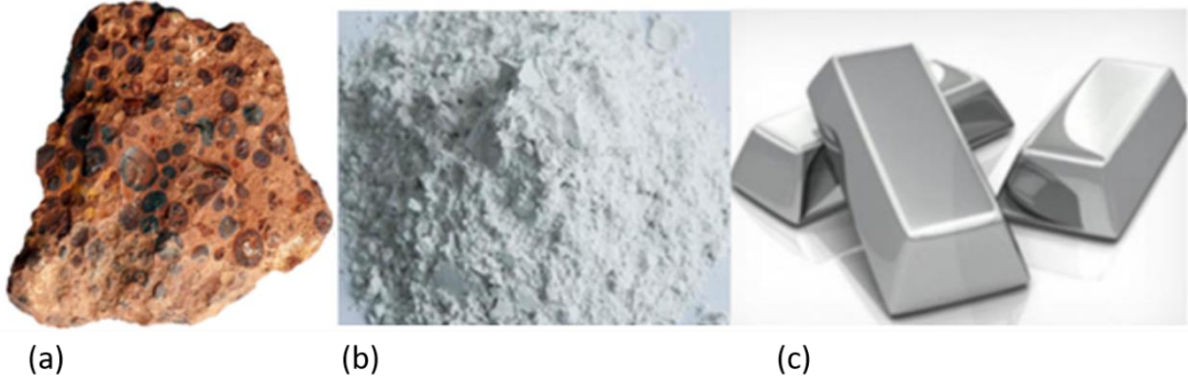
Şekil 1.1: Alüminyum üretiminde a)Boksit cevheri, b) Alüminyum oksit, c)Metalik Alüminyum
