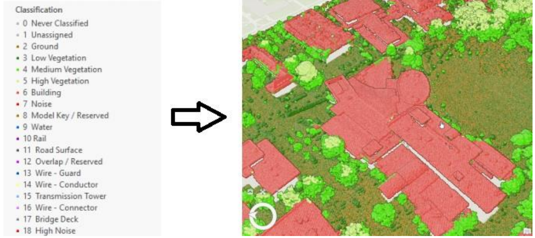
Şekil 2.4: LIDAR nokta verilerinin sınıflandırılması
