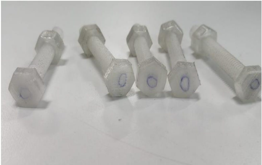
Şekil 6.10: PETG ( \pm 45^\circ ) ve ( 0/90^\circ ) Baskı Yönlerine Ait Somun ve Cıvata Numuneleri
