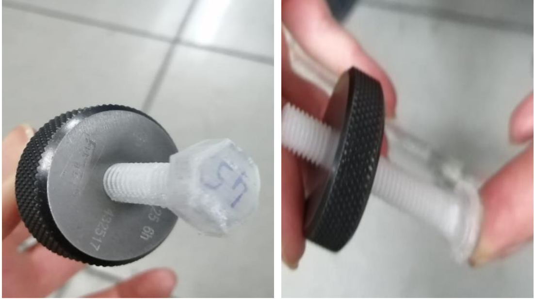
Şekil 6.6: Pafta ile Temizlenen Cıvataların Master Kontrolleri Görüntüleri
