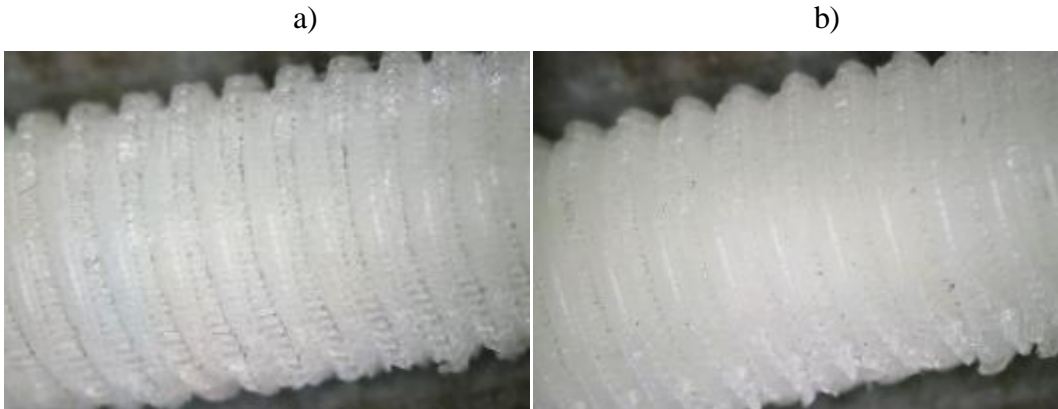
Şekil 7.20: PLA a) 0/90° Cıvata Diş b) ±45° Cıvata Diş Görüntüleri
