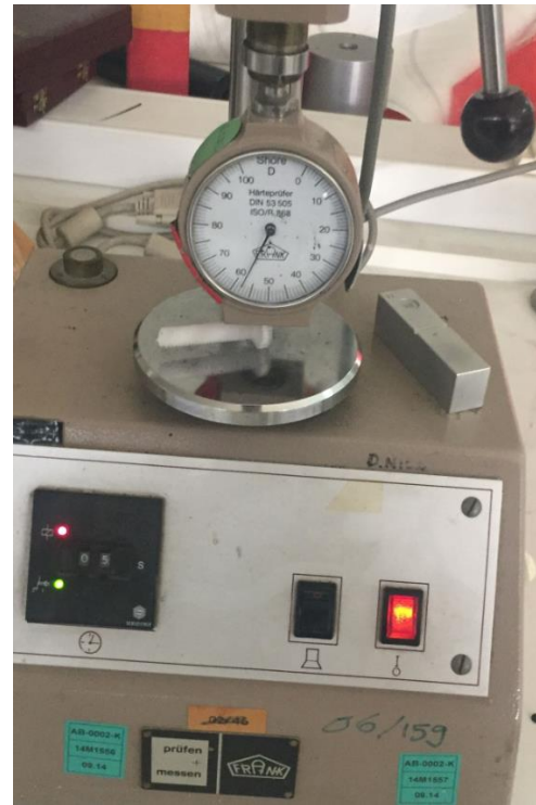
Şekil 6.8: Shore D Sertlik Analizi Yapılan Numunelere Ait Bazı Görüntüler
