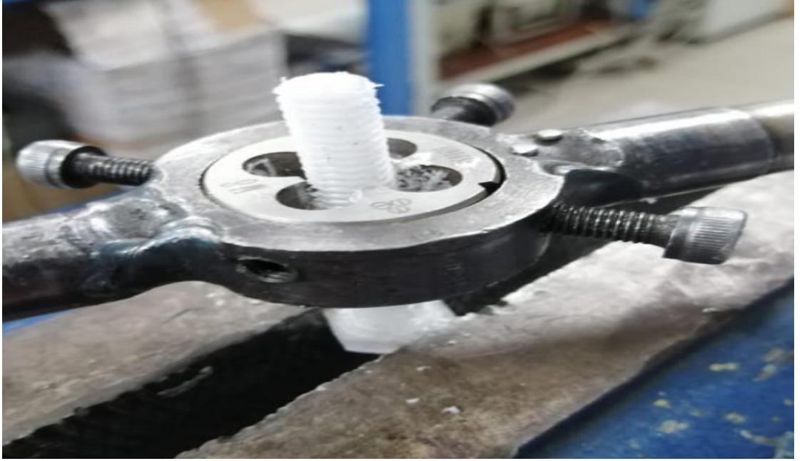
Şekil 6.5: Pafta ile Son Yüzey Temizleme İşlemi Görüntüsü
