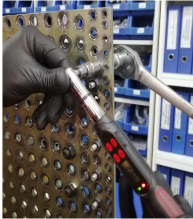
Şekil 7.9: Tork Testine Tabi Tutulan Numunelere Ait Görüntüler
