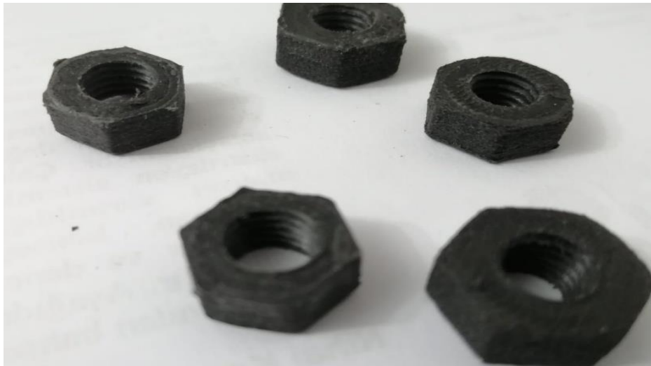
Şekil 6.12: PA6 %10 Karbon Fiberli ( \pm 45^\circ ) ve ( 0/90^\circ ) Baskı Yönlerine Ait Somun ve Cıvata Numuneleri
