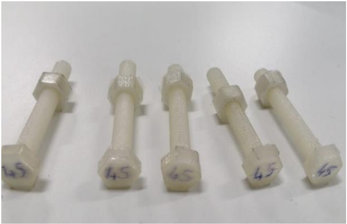
Şekil 6.11: PLA ( \pm 45^\circ ) ve ( 0/90^\circ ) Baskı Yönlerine Ait Somun ve Cıvata Numuneleri
