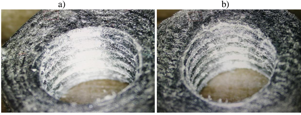
Şekil 7.15: PA6 %10 Karbon Fiberli a) 0/90° Somun Diş b) ±45° Somun Diş Görüntüleri
