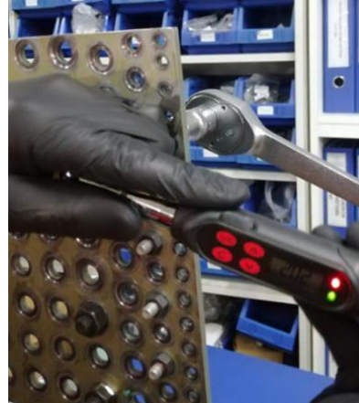
Şekil 7.9: Tork Testine Tabi Tutulan Numunelere Ait Görüntüler
