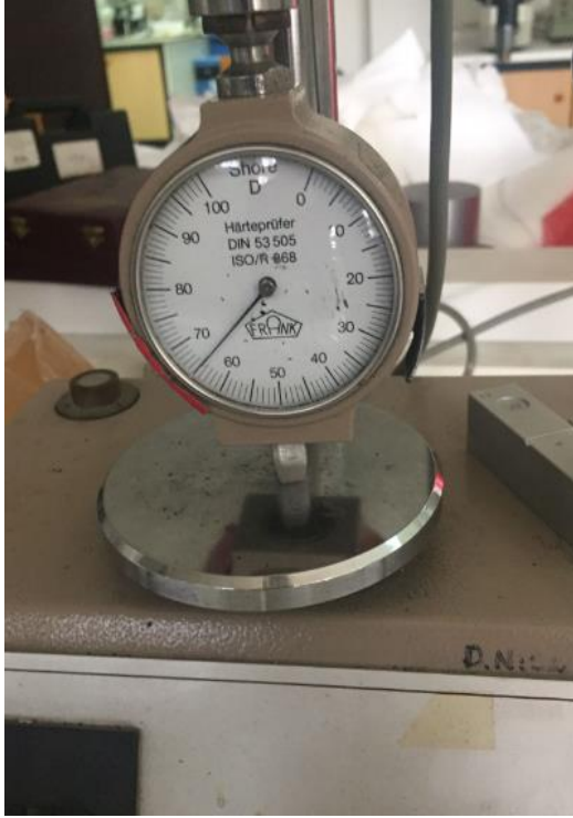
Şekil 6.9: Shore D Sertlik Analizi Yapılan Numunelere Ait Bazı Somun Görüntüleri
