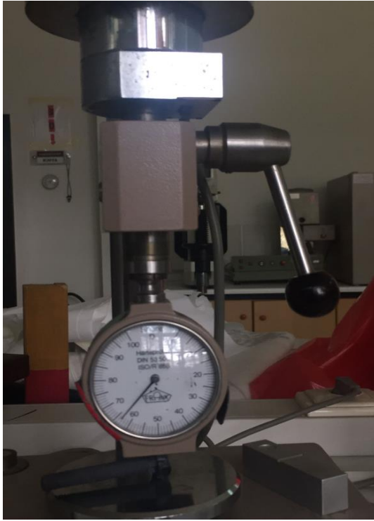
Şekil 6.8: Shore D Sertlik Analizi Yapılan Numunelere Ait Bazı Görüntüler
