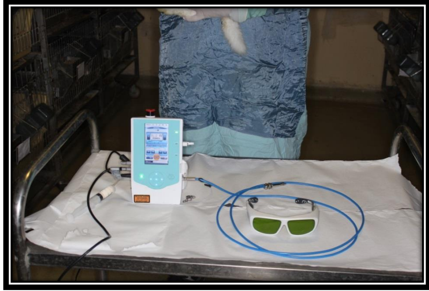
Şekil 34. DDLT amacı ile kullanılan Diyot lazer cihazı
