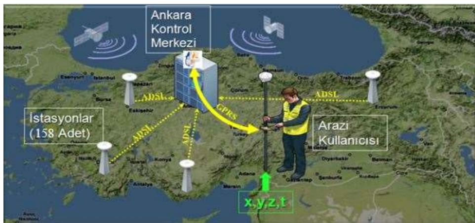
Şekil 5.12: TUSAGA-Aktif sisteminin çalışma prensibi [77]
