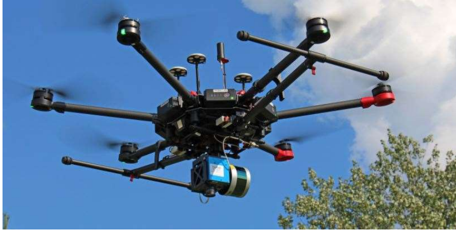
Şekil 5.6: Drone platformu altına monte edilmiş LİDAR sistemi [73]
