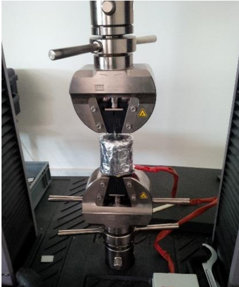
Şekil 4. 1 : Çekme testi esnasında numunelerin sıcaklığını ayarlama aparatı.
