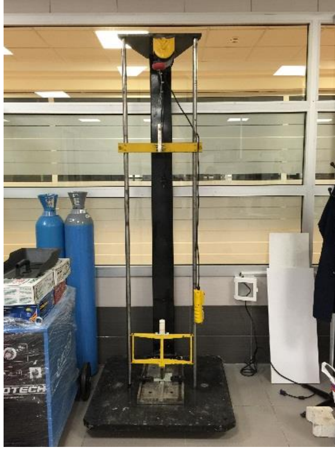
Şekil 3. 8 : Düşük hızlı darbe testi deney düzeneği
