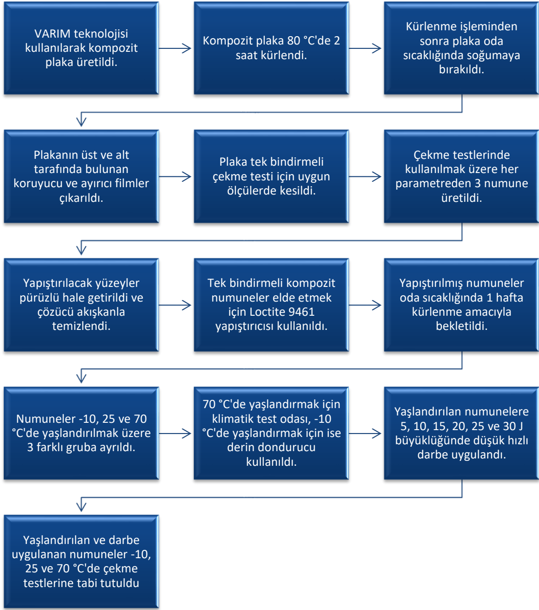
Şekil 3. 11 : Detaylandırılmış deneysel prosedür.
