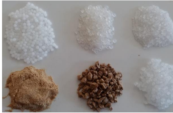
Şekil.1. 1 OPK üretiminde kullanılan odun unu, plastik, MAPP, MAPE ve pelletler [Foto M. TÜRK].
