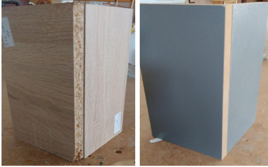
Şekil 3. 4 L tipi köşe birleştirme test numunesi [Foto M. TÜRK].
