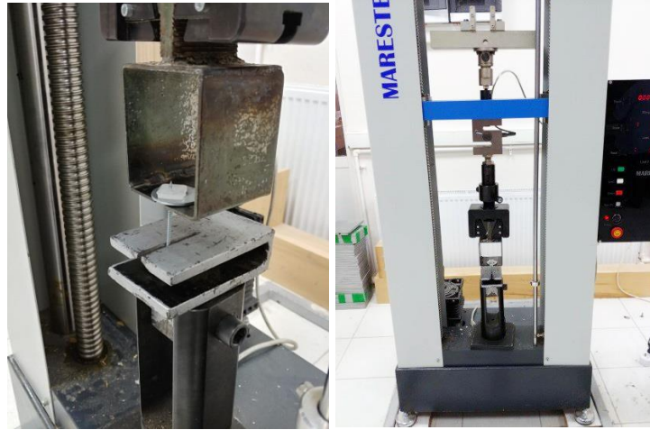
Şekil 3. 20 Deneyde kullanılan vida çekme aparatı ve Üniversal test makinesi [Foto M. TÜRK].
