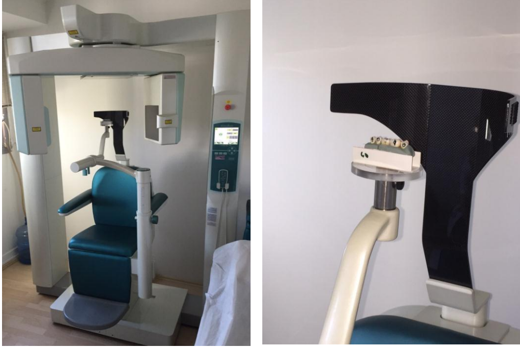
Resim 3-4 Morita 3D Accuitomo 170 Cihazı ve örneklerin görüntülenmesi
