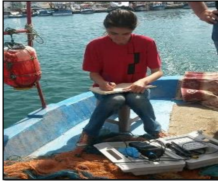
Şekil 2.3.2: Multiparametre cihazı ile gerçekleştirilen ölçümler (Orijinal).
