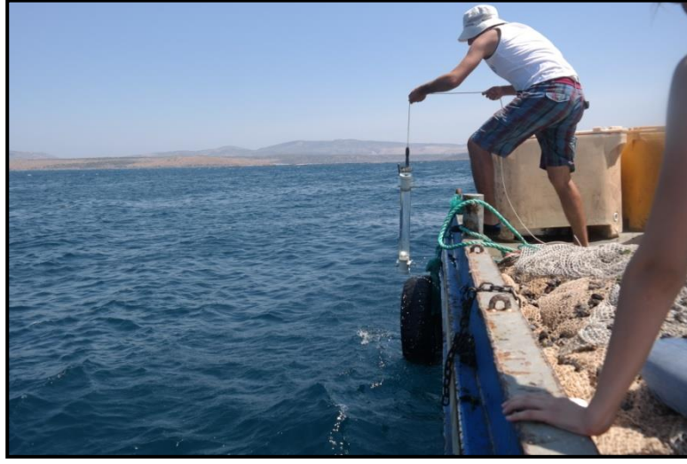
Şekil 2.3.1: Su örnekleyicisi ile su numunelerinin alınması (Orijinal).
