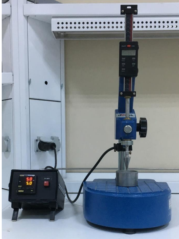
Şekil 4.6 : Düşen koni likit limit deneyi cihazı.
