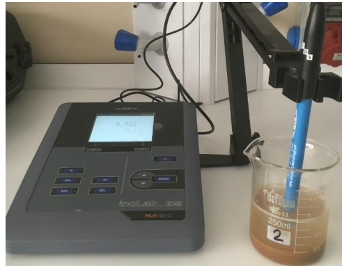
Şekil 4.8 : pH metre cihazı ve ölçümü.
