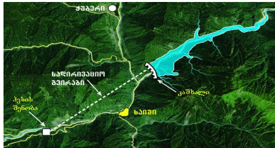
Resim 4. (10) Khudon hidroelektrik barajı şeması
