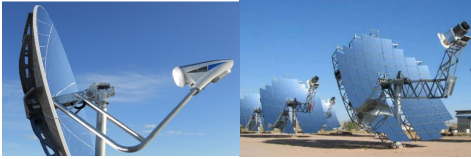
Şekil 8. Stirling motorlu parabolik çanak sistemi uygulamaları
