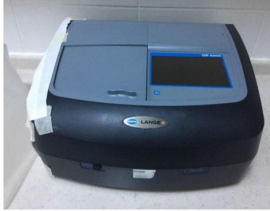
Şekil 3.11. Denemede Kullanılan Spektrofotometre (Hanch Lange DR6; Orjinal).
