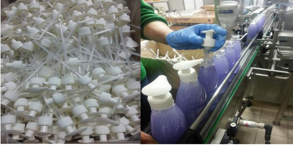
Şekil 2.2 Sıvı sabun hatları dispenser kapak takılması.
