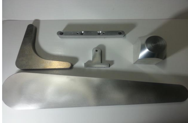
Şekil 4.3 7075 T651 Alüminyum kullanarak talaşlı imalatı.
