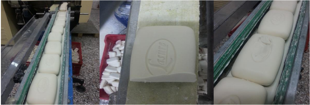
Şekil 2.1 Damga makinası çıkışı, hatalı sabun gösterimi.
