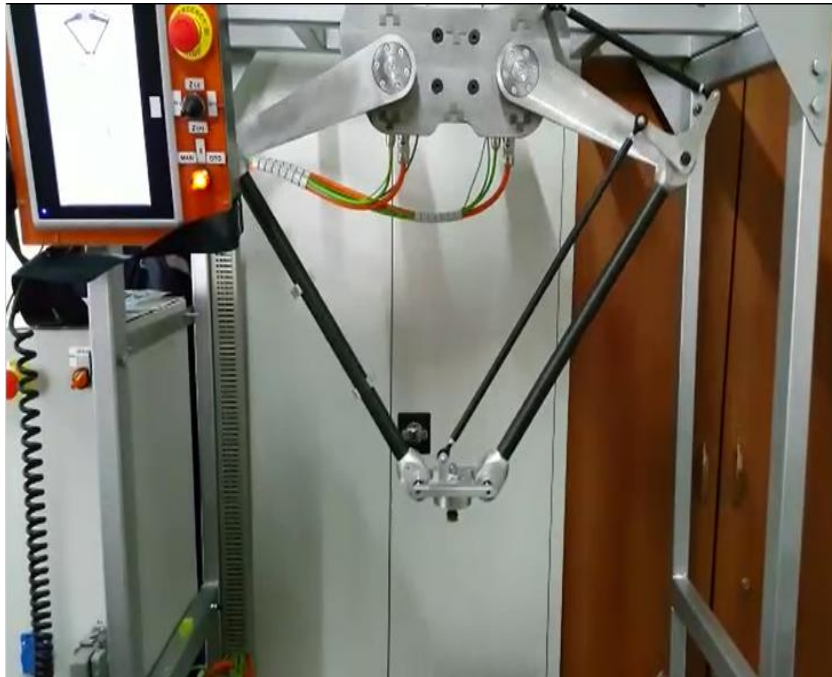
Şekil 5.10 Paralel mekanizmanın montajı ve çalıştırılması.
