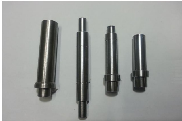
Şekil 4.4 16MnCr5 Sementasyon Çeliği kullanarak talaşlı imalat.
