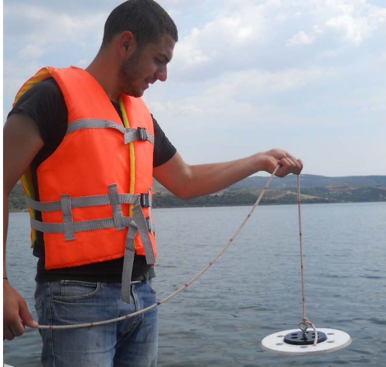
Şekil 2.3.3: Secchi diski ile gerçekleştirilen ölçümler (Orijinal).
