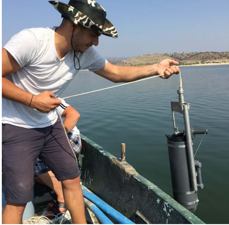
Şekil 2.3.1: Su örnekleyicisi ile su numunelerinin alınması (Orijinal).
