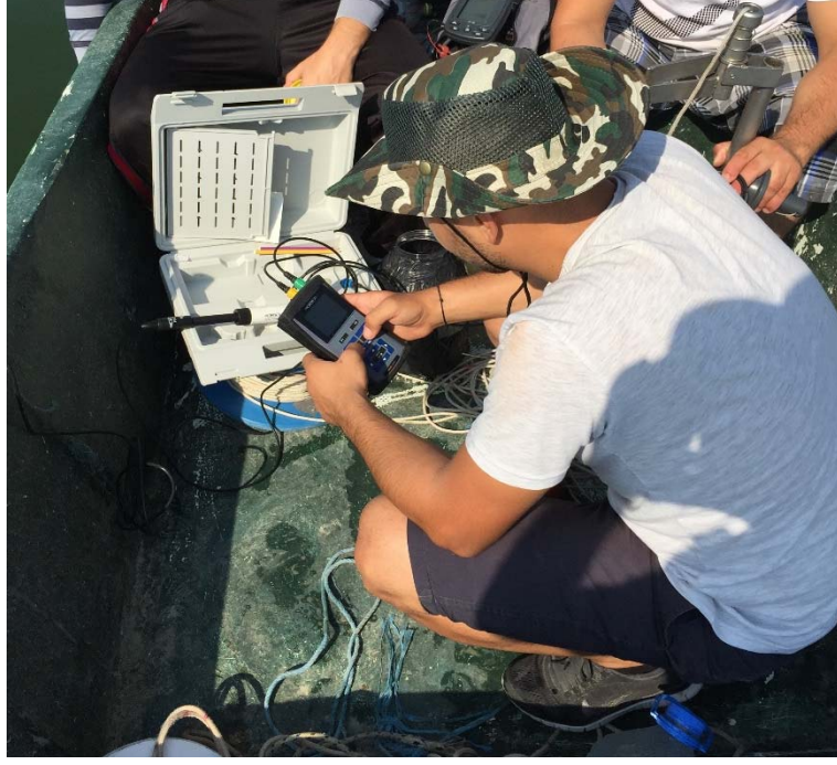
Şekil 2.3.2: Multiparametre cihazı ile gerçekleştirilen ölçümler (Orijinal).
