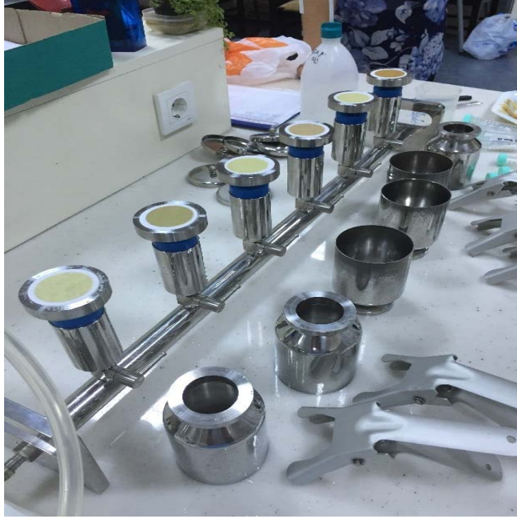
Şekil 2.4.3: Manifold kullanılarak gerçekleştirilen süzme işlemi (Orijinal).
