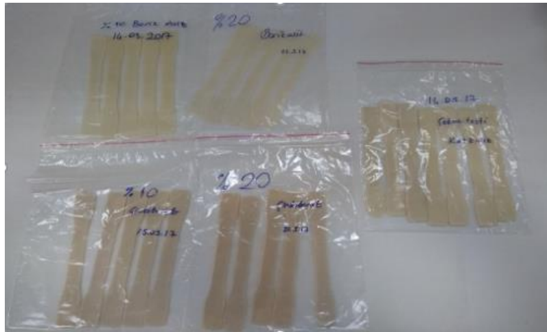
Şekil 2. 3:Çekme Testi Numune Şekli
