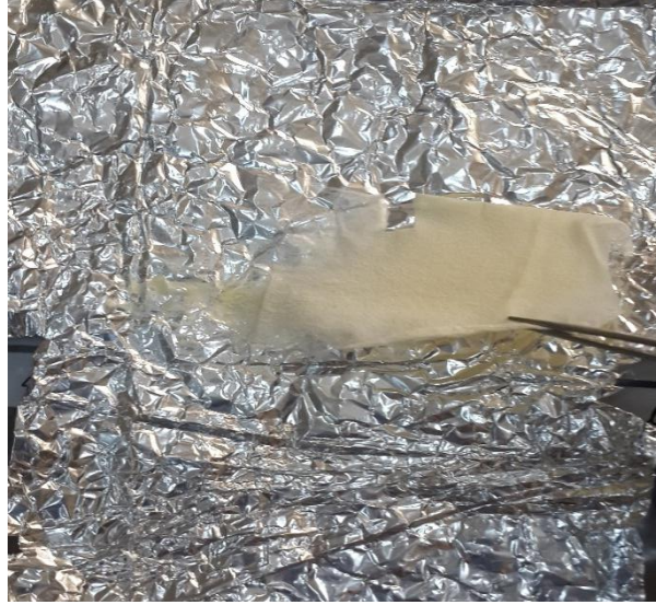
Şekil 2.2: Çalışmada elektroğirme tekniği ile elde edilen bir nanolifin görüntüsü.
