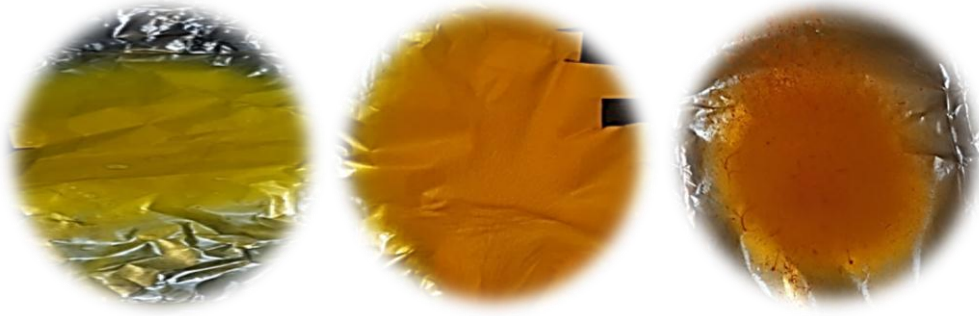
Şekil 3.21: (a) Kütlece farklı konsantrasyonlardaki (% 1-5-10) CUR/PU çözeltilerinden elde edilen nanoliflerin ve kontrol grubunun (% 12.5 PU) temas açıları (Uygulanan potansiyel: 12.5 kV, Akış hızı: 1.00 ml/h ve Uç-toplaç mesafesi: 17 cm, PU yüzdesi: % 12.5) (b) Elde edilen CUR/PU nanoliflerinin soldan sağa (kütlece % 1-5-10) fotoğraf görüntüsü.
