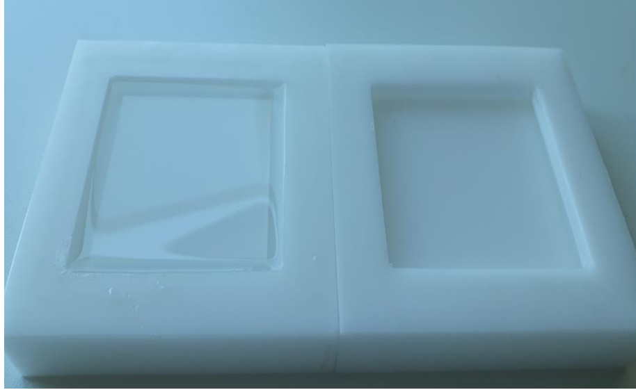
Şekil 2.6. Kompozit yapı için oluşturulan kalıp.
