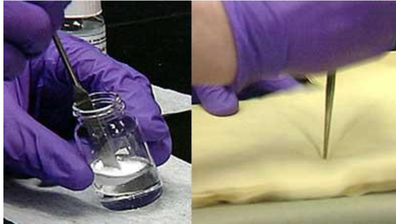
Şekil 1.1. Kayma gerilimi altında kalınlaşan akışkan ve bununla üretilmiş fiberli zırh malzemesi.
