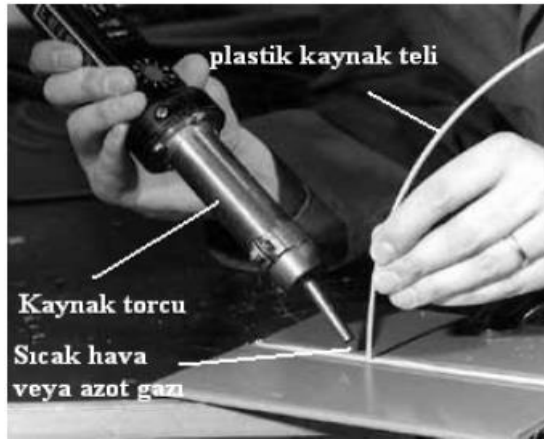
Şekil 3.2: Sıcak gaz kaynağı uygulaması [25]
