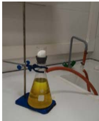
Şekil 4.7 : Hemiselüloz tayini için gauche krozesi ile süzme işlemi.
