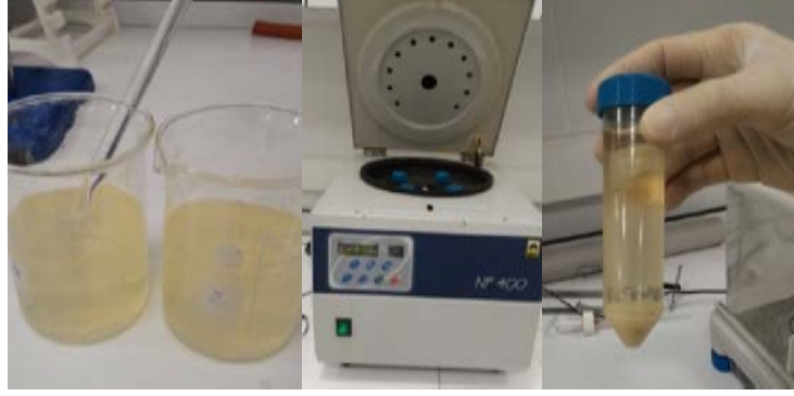
Şekil 4.8 : Soğuk etanol ile hemiselülozun çöktürülmesi ve santrifüj ile ayrılması.
