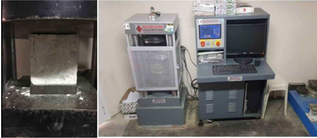
Şekil 3.8 : Otomatik pres ve küp numune basınç kırılması.
