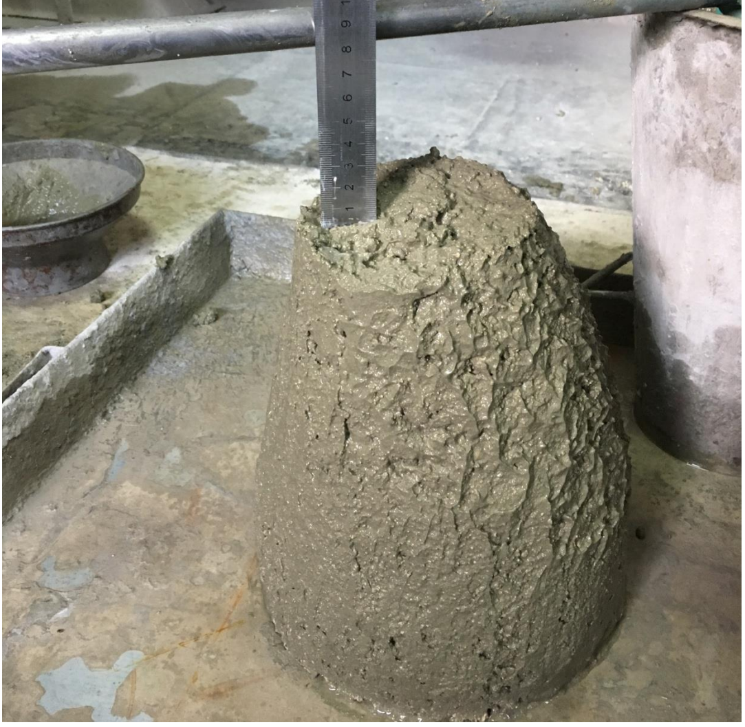
Şekil 3.7 : Çökme değerinin ölçülmesi.
