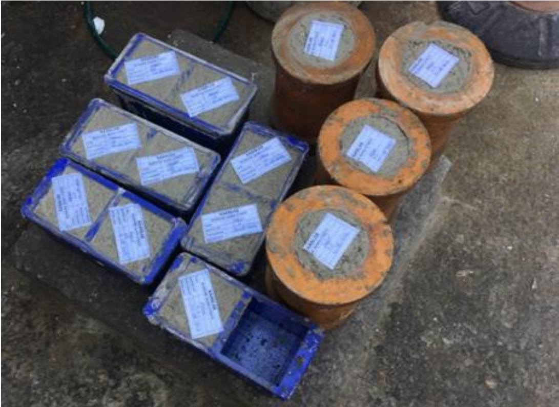
Şekil 3.5 : Beton kalıplarının doldurulması.
