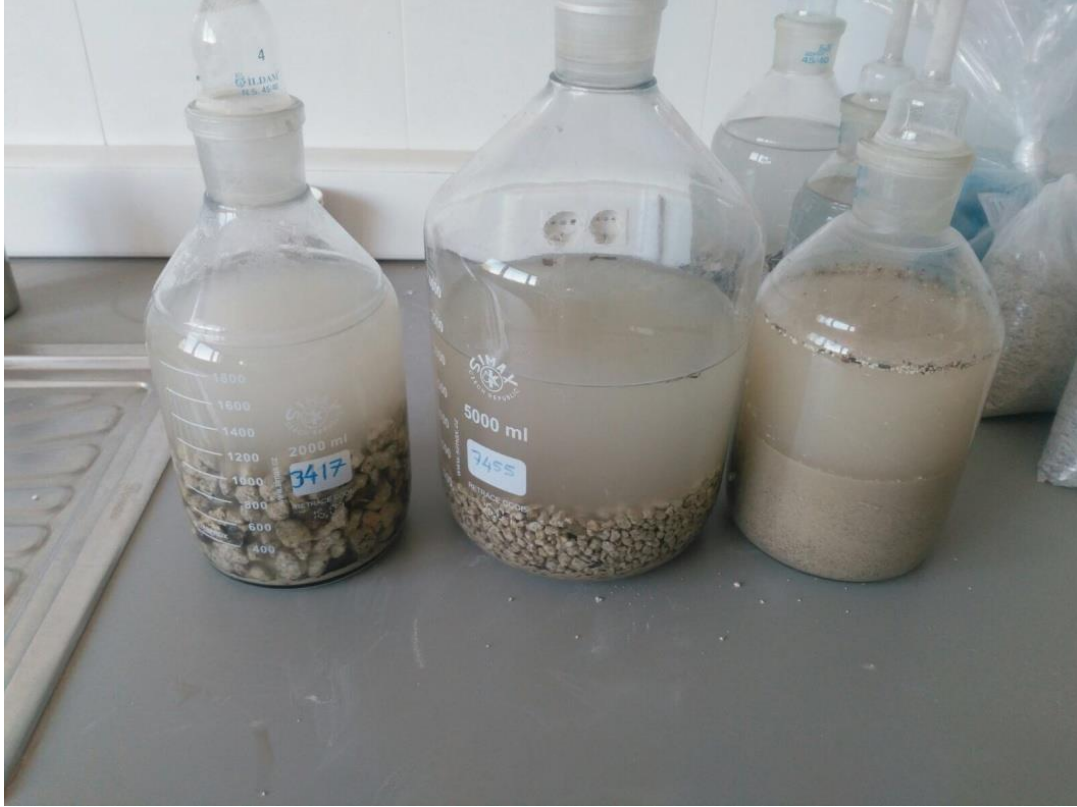
Şekil 3.4 : Agregaların DKY özgül ağırlık ve su emme tayini analizi.
