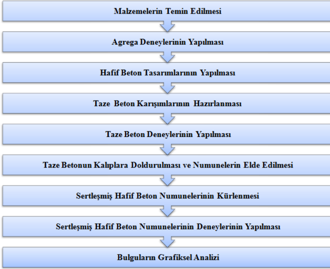
Şekil 3.3 : Deneysel çalışmaların akış şeması.
