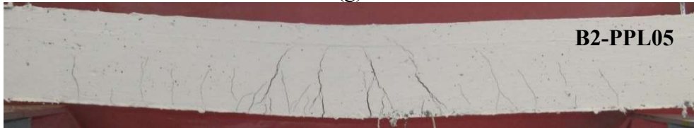
Şekil 16: B1 serisinde gözlemlenen hasar durumları, (a) B1-kontrol (etriyesiz), (b) B1-kontrol (etriyeli), (c) B1-ÇL05, (d) B1-ÇL10, (e) B1-PPL-05, (f) B2-kontrol (etriyesiz), (g) B2-ÇL10, (h) B2 PPL05.
