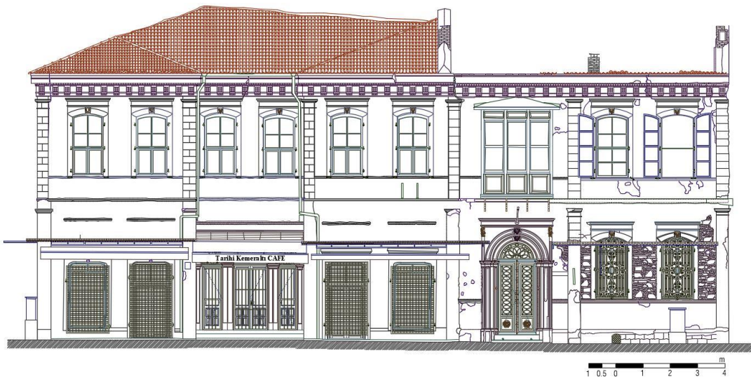
Şekil 4.24 : Ahmet Ağa Konağı restorasyon uygulaması öncesi rölöve
