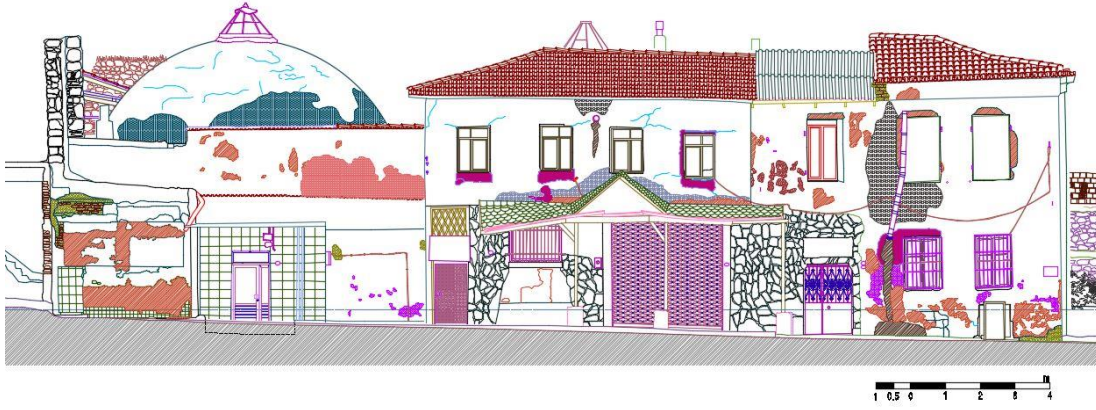
Şekil 4.33 : Namazgah Hamamı giriş (kuzey) cephesi - rölöve [87]
