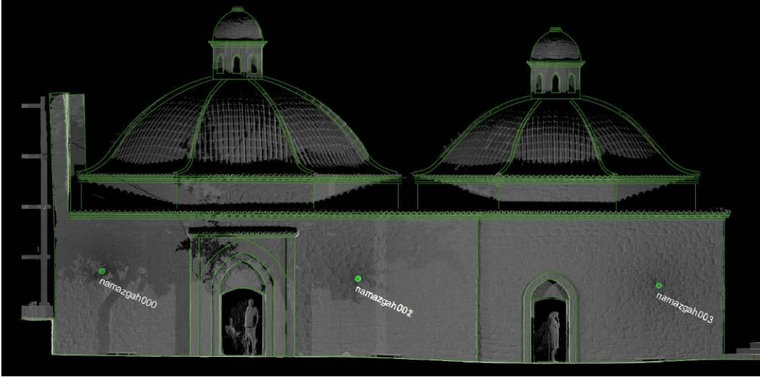
Şekil 4.56 : Lazer tarama verisi üzerinden cephe çizimi
