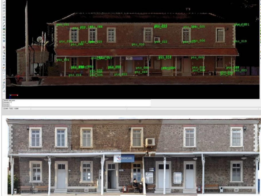
Şekil 3.43 : Zmap programında nokta bulutuna, alanda çekilen fotoğrafların yerleştirilmesi [74]
