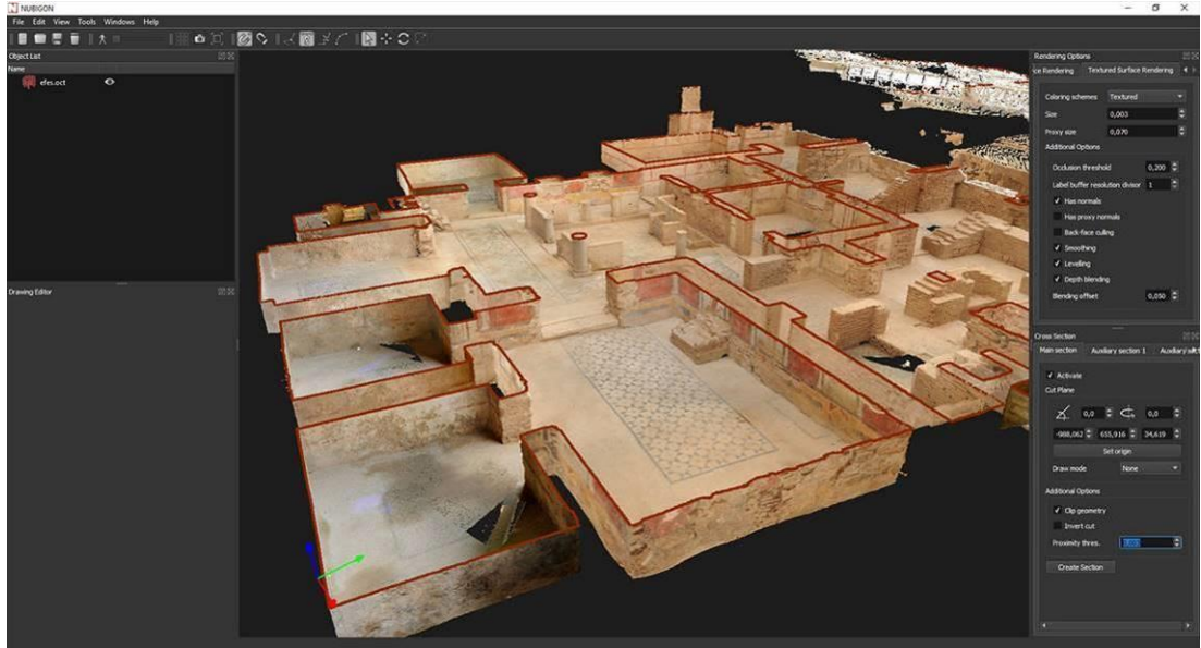
Şekil 3.48 : Nubigon programında nokta bulutu üzerinden teknik çizim yapılması [79]
