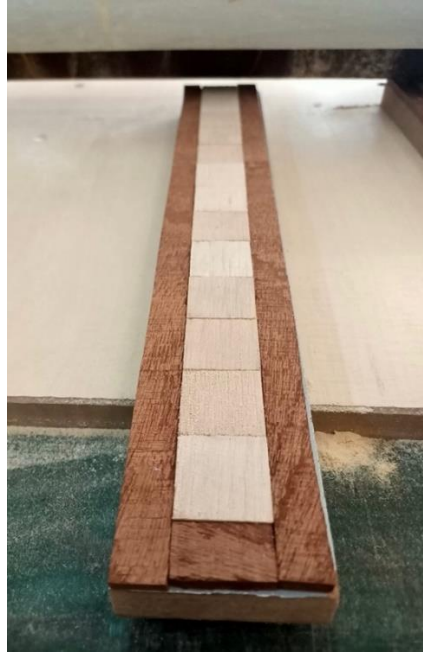
Şekil 3.2: Küçük boyutlu örneklerin kalınlık makinasında standart kalınlığa getirilmesi işlemi.
