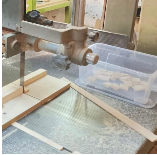
Şekil 3.1: Küçük boyutlu örneklerin gönyeleme aparatıyla şerit testerede kesim işlemi
