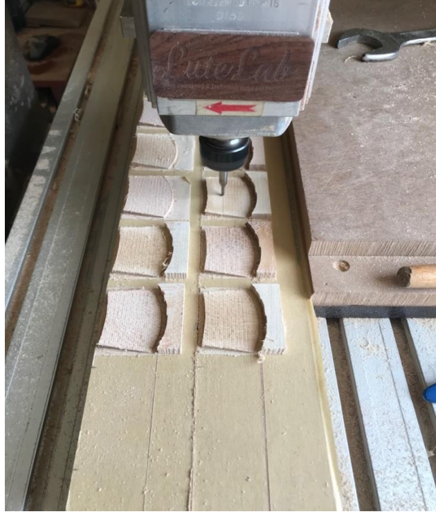
Şekil 3.17: Köprülerin cnc router ile üretim aşaması
