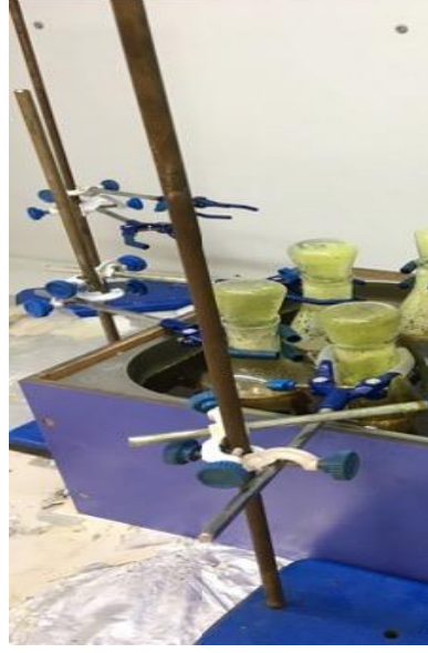
Şekil 3.8: Delignifikasyon işlemi yapılan düzenek
