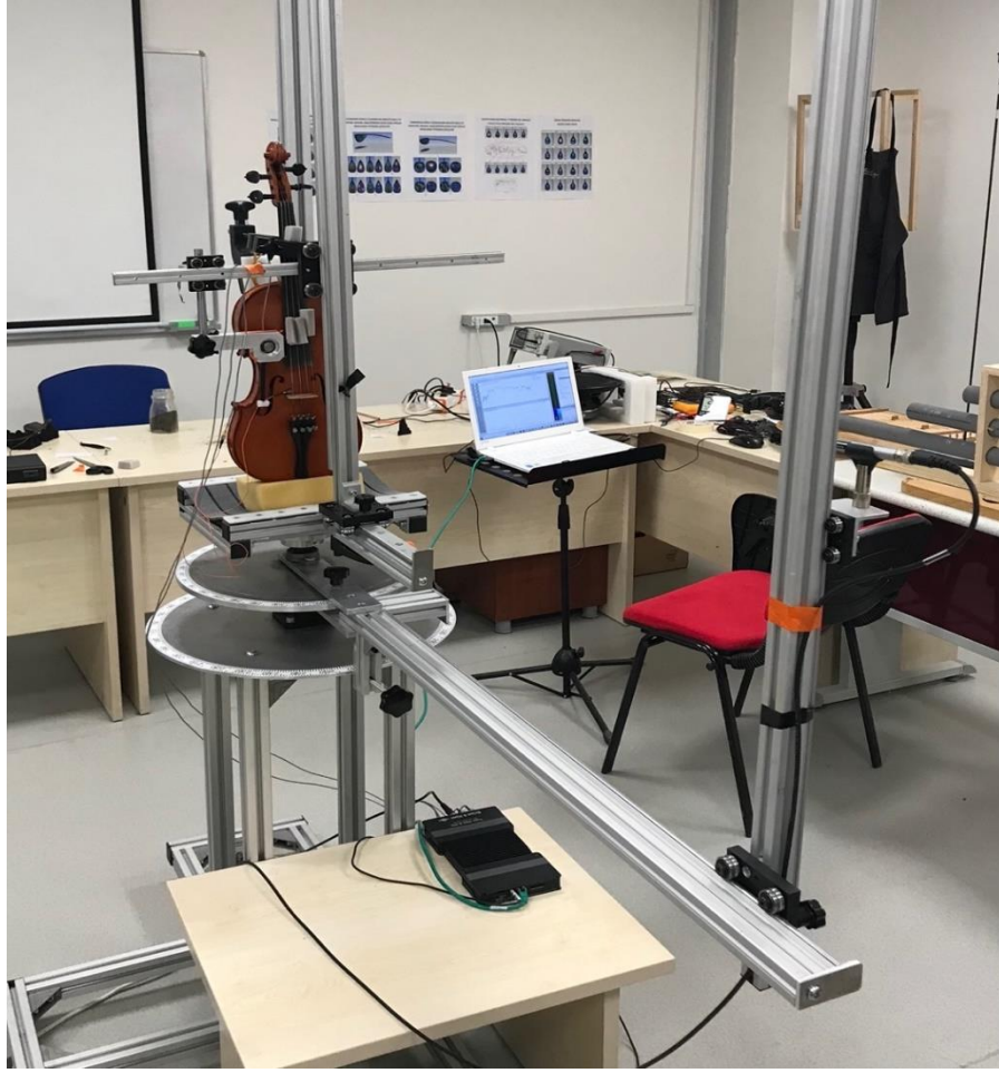
Şekil 3.19: Akustik ölçümlerin yapıldığı test düzeneği
