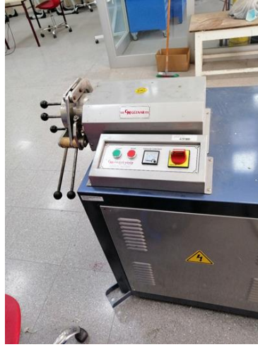
Şekil 2.8 : Yüksek hızlı termokinetik karıştırıcı.
