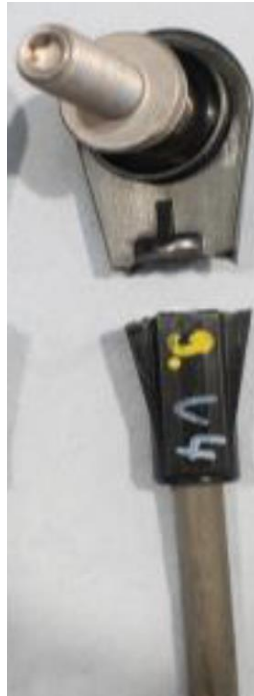
Şekil 36 Yorulma testinden sonra polimer kafa kısmıyla metal rod'un birleşim bölgesinden kırılan 4.Numune'nin görüntüsü
