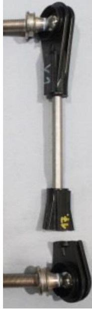
Şekil 40 Yorulma testinden sonra polimer kafa kısmıyla metal rod'un birleşim bölgesinden kırılan 3.Numune'nin görüntüsü
