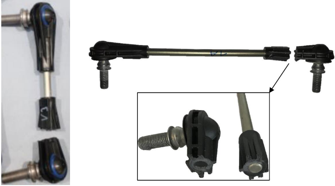
Şekil 35 Yorulma testinden sonra polimer kafa kısmıyla metal rod'un birleşim bölgesinden kırılan 3.Numune'nin detaylı görünüşü.
