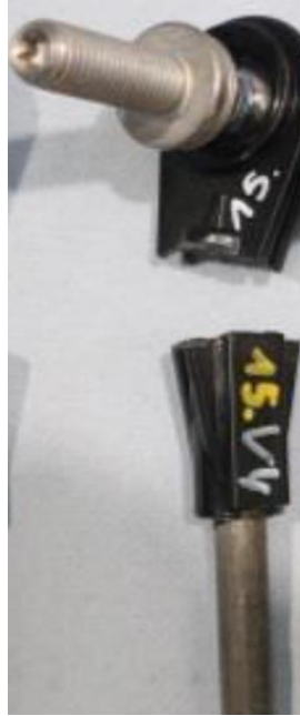
Şekil 41 Yorulma testinden sonra polimer kafa kısmıyla metal rod'un birleşim bölgesinden kırılan 4.Numune'nin görüntüsü.
