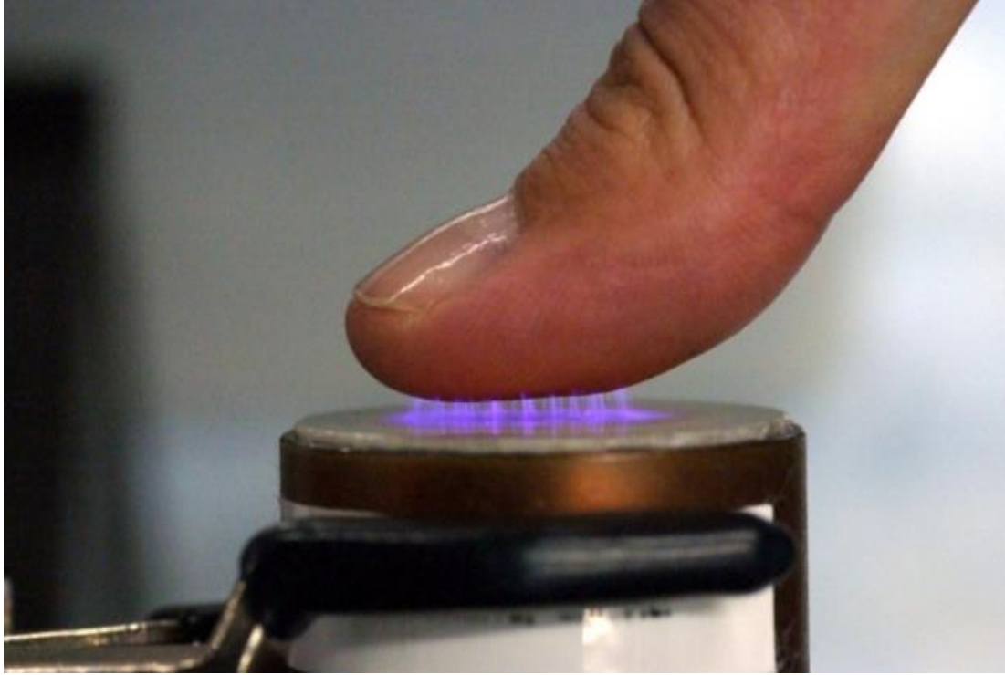
Şekil 1.6: Canlı doku ile doğrudan temas halinde olan Yüzen Elektrot Dielektrik Bariyer Deşarj (FE-DBD) plazmasının fotoğrafı [26]
