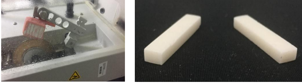
Resim 10: Bar şeklindeki örneklerin hazırlanması
