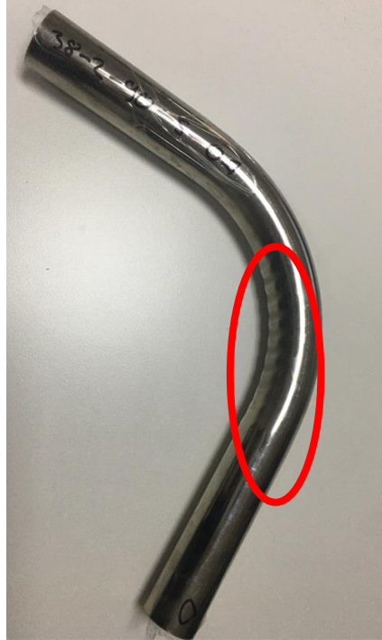
Şekil 4.3: Boru bükme işlemi sonrası görsel kusur
