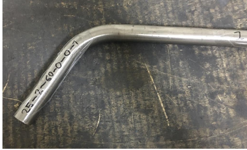
Şekil 4.1: Deney numunesi kodlama örneği
