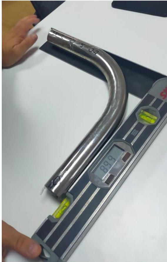
Şekil 4.2: Boru bükme işlemi sonucunun ölçüm yapılarak kontrolü
