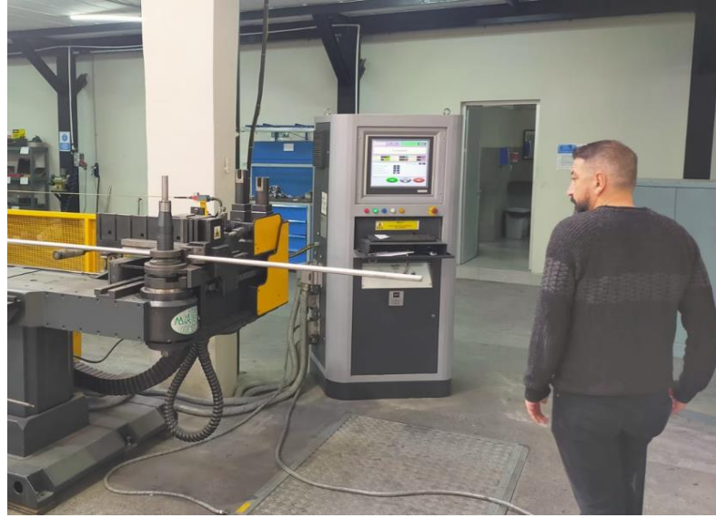
Şekil 2.4: CNC boru bükme operasyonu
