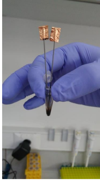
Şekil 3.14: Grafit elektrotun grafen oksit (daldırma) ile modifiye edilmesi
