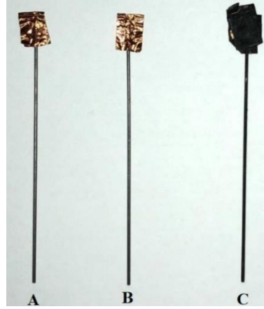
Şekil 4.11: PGE elektrotlarının kaplama görüntüleri: A) Şartlandırılmış grafit elektrot B) Grafen oksit (daldırma) modifiye elektrot C) Grafit elektrot üzerinde MoS 2 büyümesi
