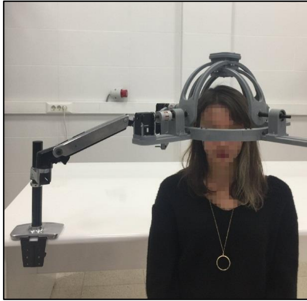
Şekil 4.3 Manipülâtörün insan kafatası üzerinde hizalanması
