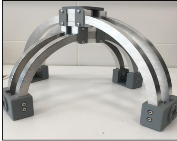
Şekil 6.6 Sistem girdi bağlantılarının (büyük yay ve küçük yay) montajının tamamlanması
