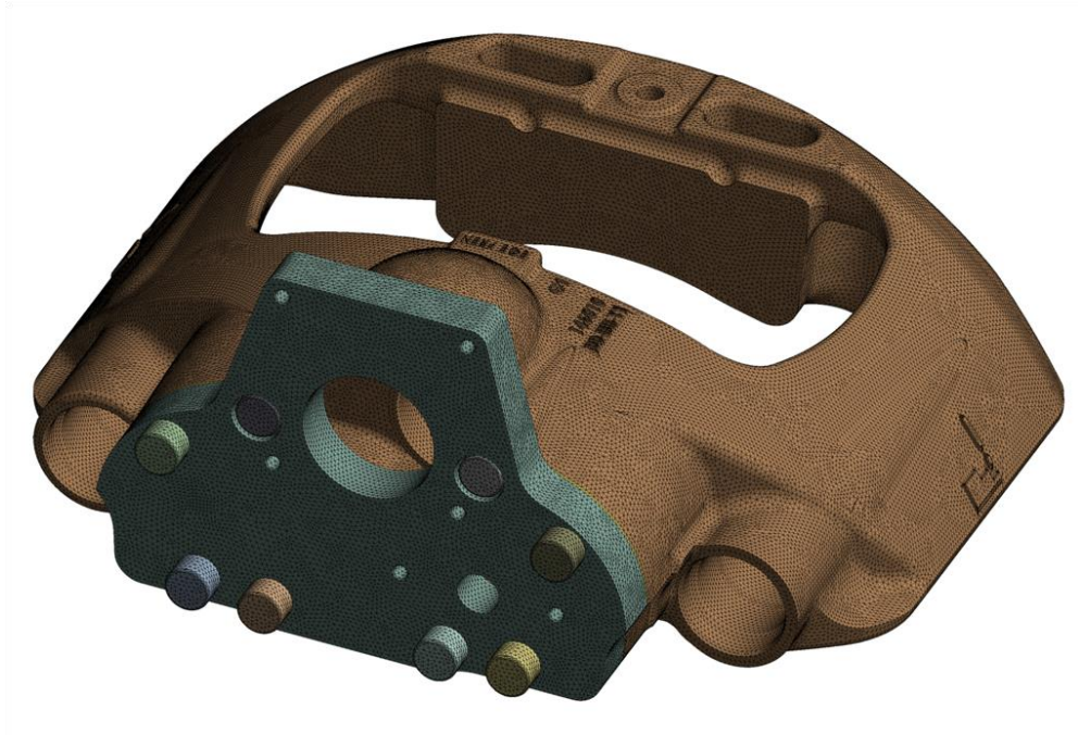
Şekil 3.39: Kaliper yuvası – kapak montajı gerilme analizleri – Sonlu elemanlar ağı
