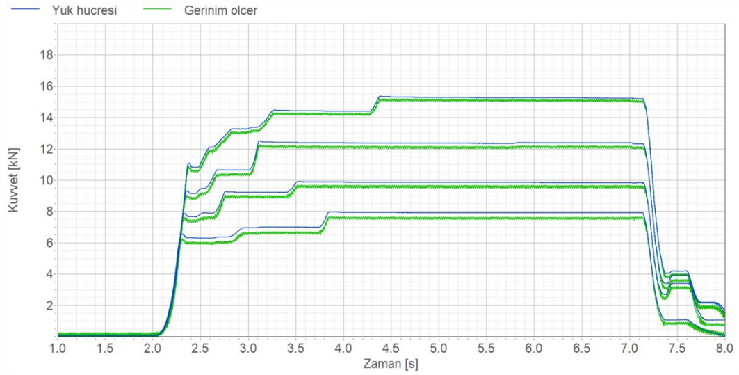
Şekil 5.10: Yük hücresi – gerinim ölçer verilerinin karşılaştırılması (PID V2)
