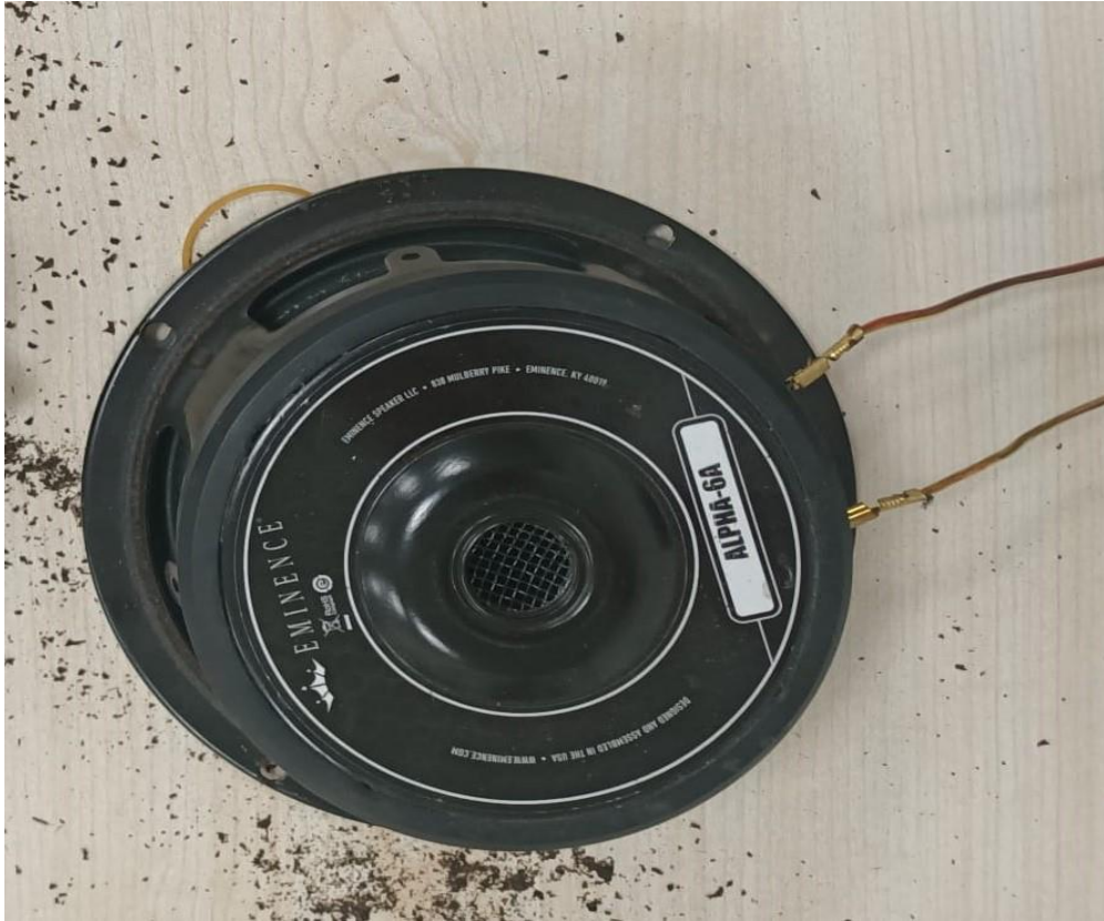
Şekil 3.15: Chladni metodu için kullanılan Eminence 6 marka hoparlör
