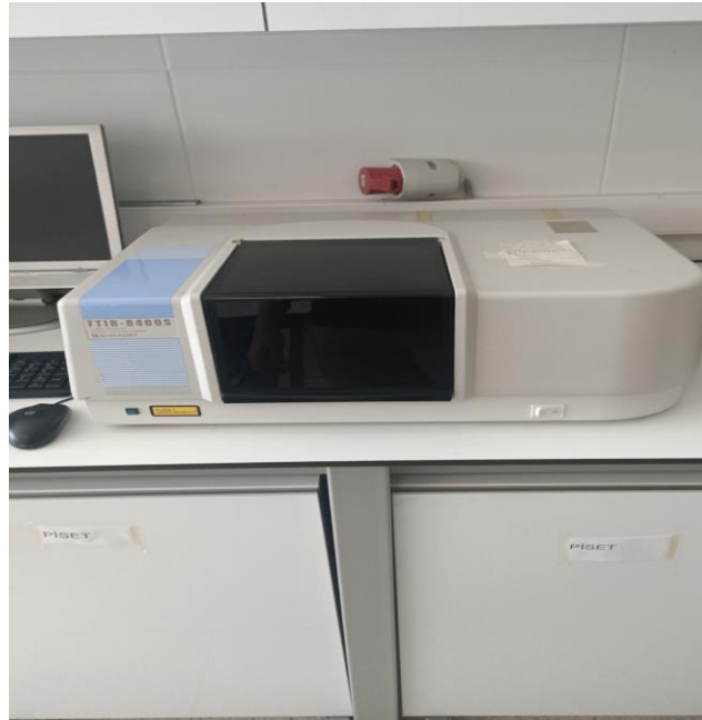
Şekil 3.7: FTIR analizlerinin gerçekleştirildiği cihaz
