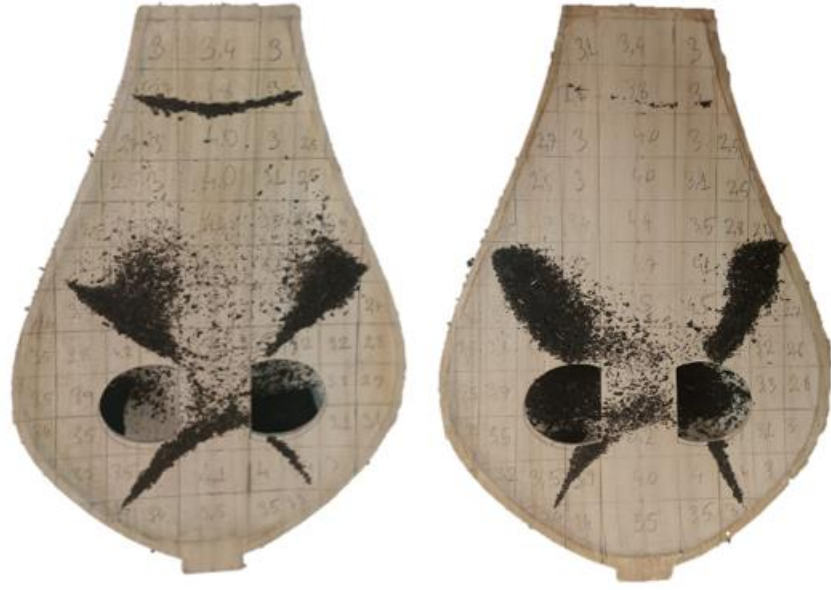
Şekil 4.11: Soldaki modifikasyonlu ses tablasının 532 Hz doğal frekansındaki görünümü, Sağdaki kontrol ses tablasının 513 Hz doğal frekansındaki görünümü
