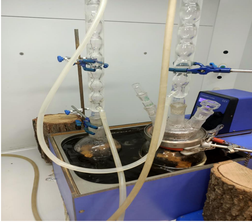
Şekil 3.10: Küçük boyutlu odun örneklerinin kimyasal modifikasyon işleminin gerçekleştirildiği düzenek
