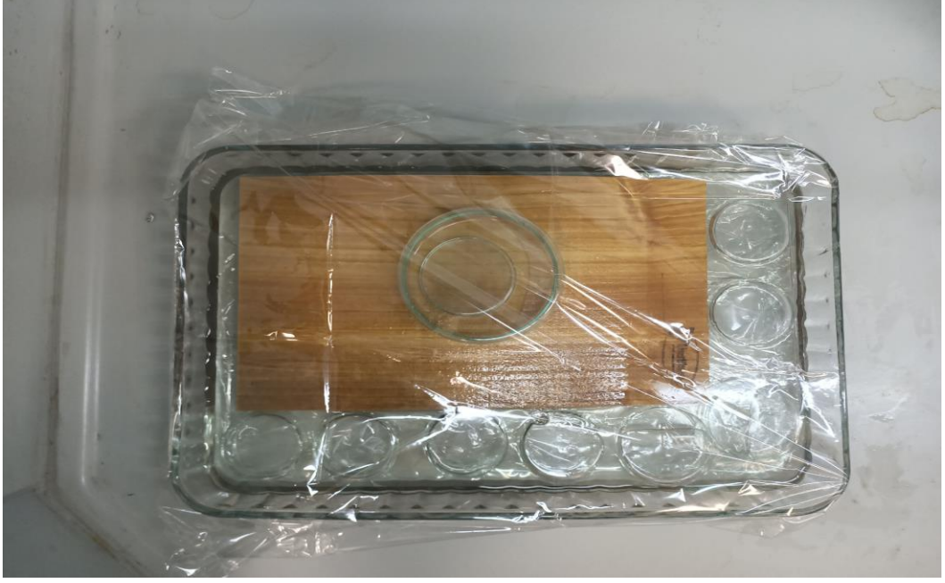
Şekil 3.12: Büyük boyutlu servi örneğinin kimyasal modifikasyonun gerçekleştiği düzenek
