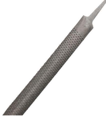
Şekil 1.10: Yapım aşamasında kullanılan törpü [37]
