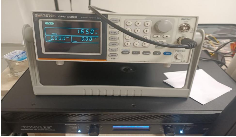
Şekil 3.14: Chladni testi için kullanılan GW Instek AFG-2005 marka fonksiyon jeneratörü ve TONYLEE VS600 marka power amfi
