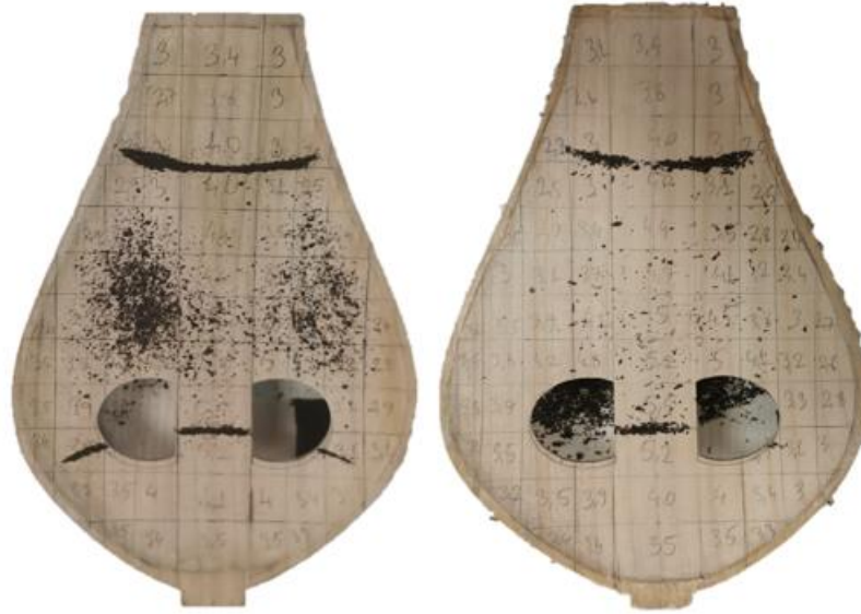
Şekil 4.10: Modifikasyonlu ve Kontrol ses tablalarının 254 Hz doğal frekanslarındaki görünümleri (Soldaki kimyasal modifikasyonlu, Sağdaki kontrol ses tablası)
