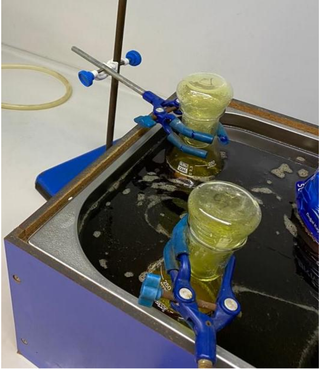
Şekil 3.5: Delignifikasyon uygulamasının yapıldığı düzenek
