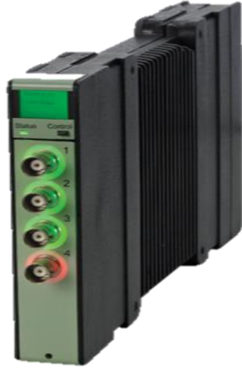
Şekil 3.19: Ses yayılım analizinde kullanılan B&K 3050-A-060 ses kartı
