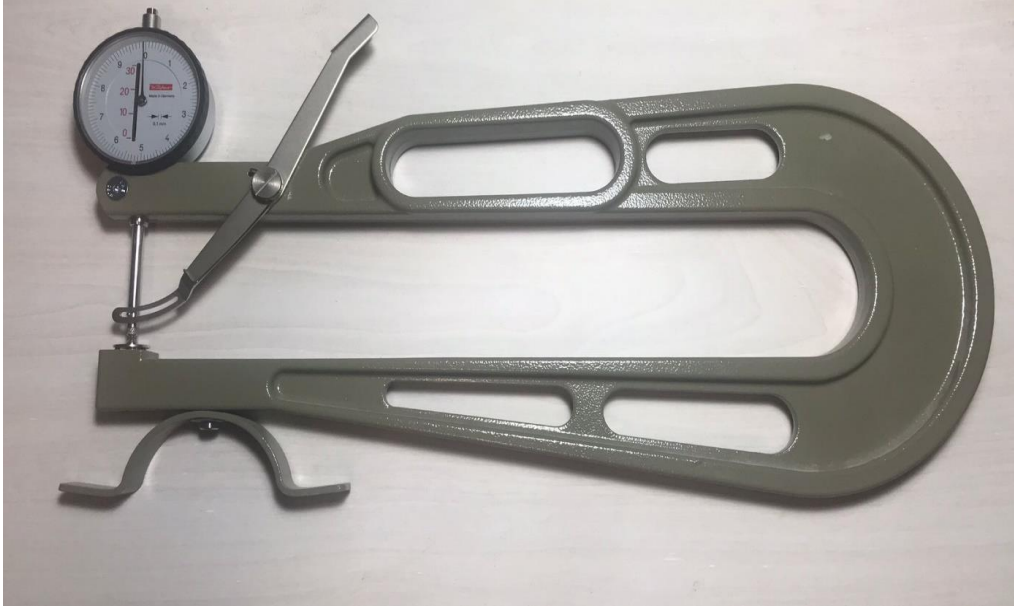
Şekil 1.13: Ölçülendirilmelerin yapımında kullanılan komparatör
