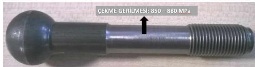
Şekil 5.24 : Rotmili şaft bölgesi çekme test numunesi
