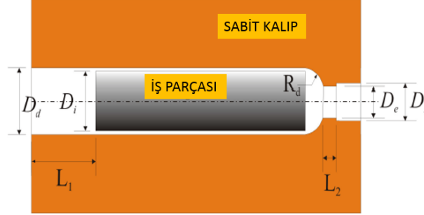
Şekil 3.10 : Ekstrüzyon kalıbı ve iş parçası pozisyonu
