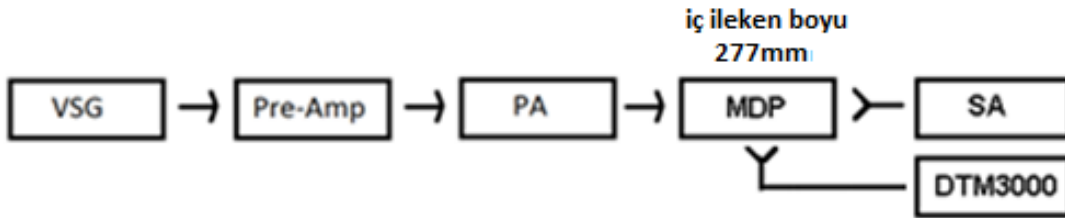
Şekil 4.19: İç iletken boyu 277 mm olan MDA prop deneme V1'in zayıflatıcı kullanılmayan deney düzeneğinin blok diyagramı.
