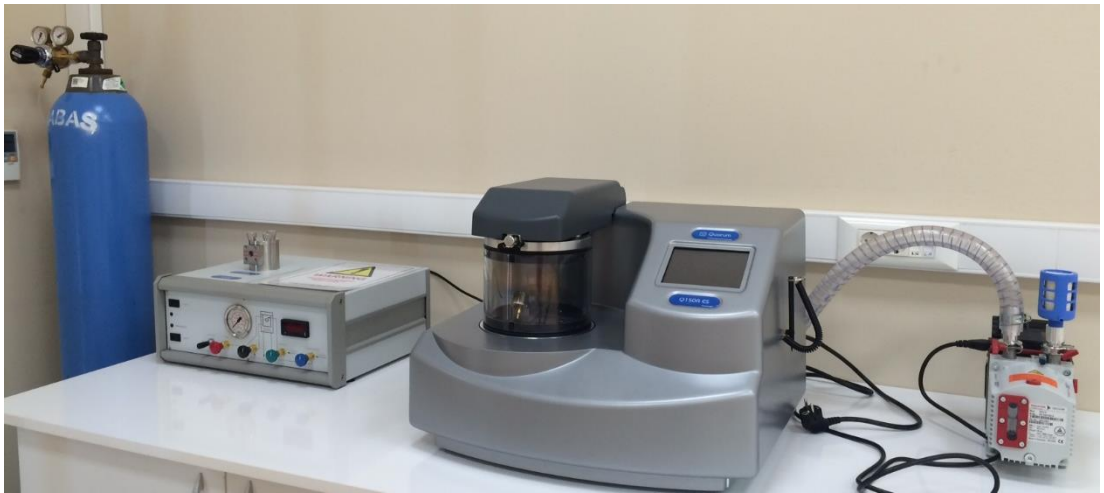
Şekil 2.6 QUORUM Q150 RES kaplama cihazı
