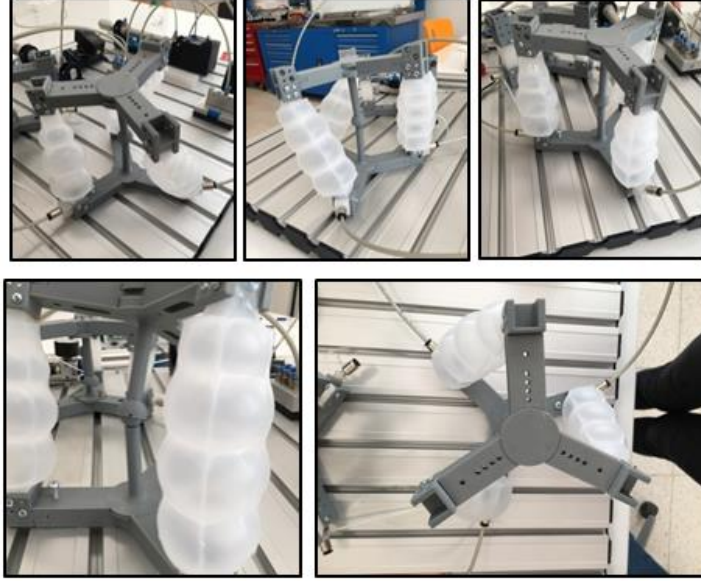
Şekil 3.30: Montajı tamamlanan yeni manipülâtörün hareket durumu
