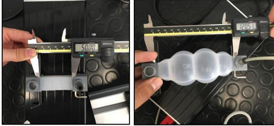
Şekil 3.25: Yumuşak eyleyicinin pnömatrik basınç altında uzama durumu
