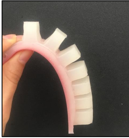
Şekil 2.12: Mukavemetinin düşük olmasından kaynaklı gözlenen bükülme
