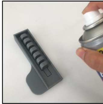
Şekil 2.18: Kalıba silikon kalıp ayırıcı sıkılması
