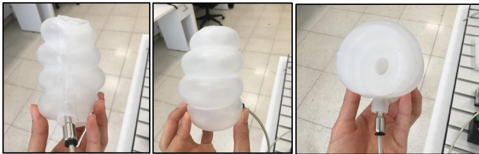
Şekil 3.16: Donut şeklindeki yumuşak eyleyicinin şişmiş halinin farklı açılardan görüntüsü
