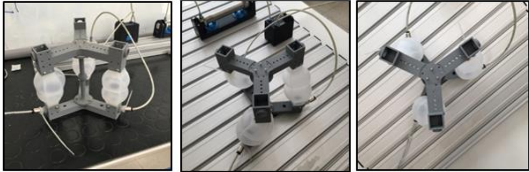
Şekil 3.26 : Montajı tamamlanan manipölatörün hareket durumu
