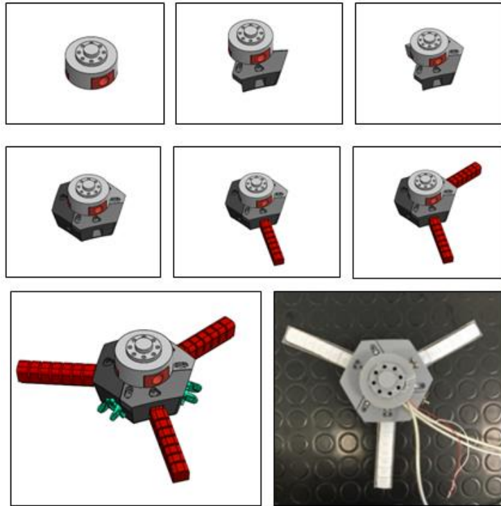
Şekil 2.29: Modüler el ayasının montaj aşamaları ve nihai hali
