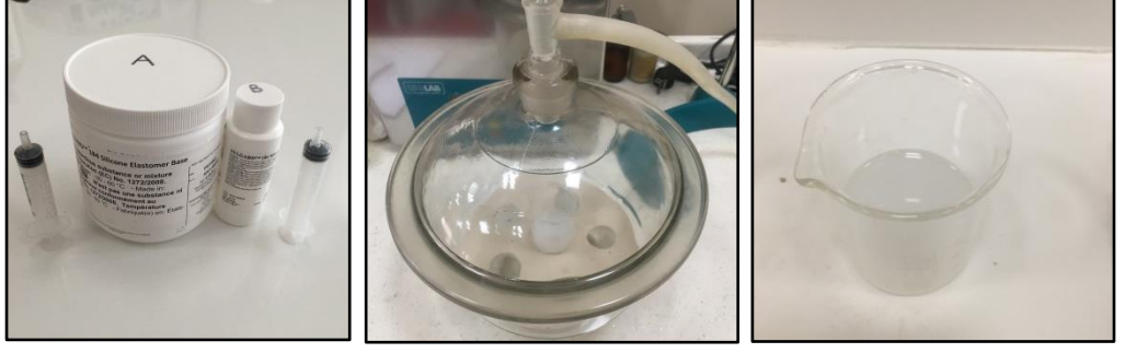
Şekil 2.25: PDMS karışımının hazırlanarak vakum çemberinde bekletilmesi
