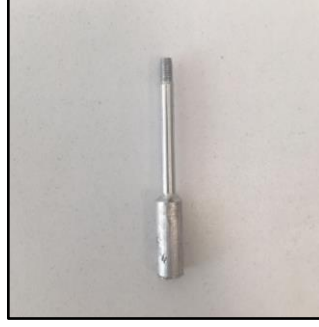
Şekil 2.16: Boş hacmin oluşması için kalıba monte edilecek parçanın görüntüsü
