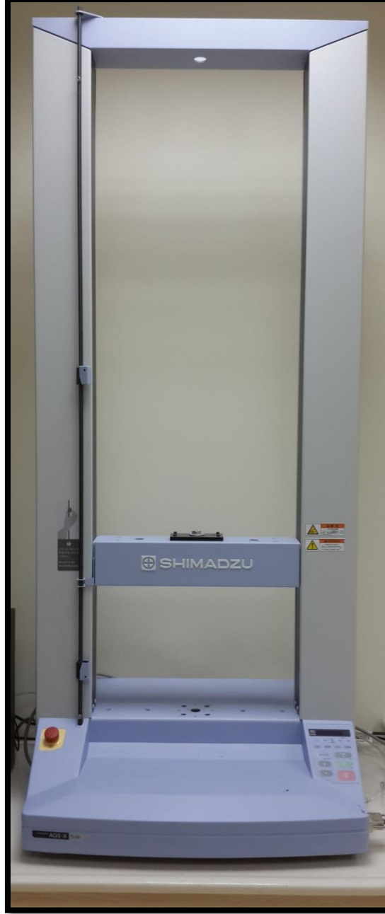
Resim 3-25: Üiversal test cihazı (Shimadzu, Model AGS-X 5kN, Shimadzu Corporation, Kyoto, Japonya)
