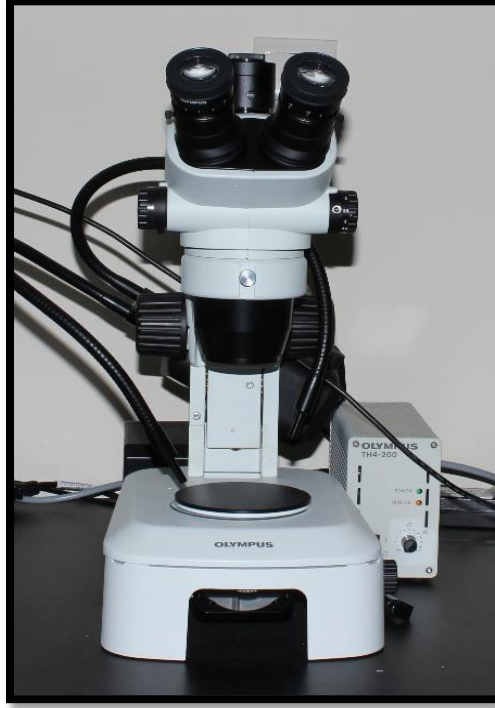
Resim 3-23: Stereo Mikroskop (Olympus SZ61, Olympus Optical Co, Tokyo, Japonya)
