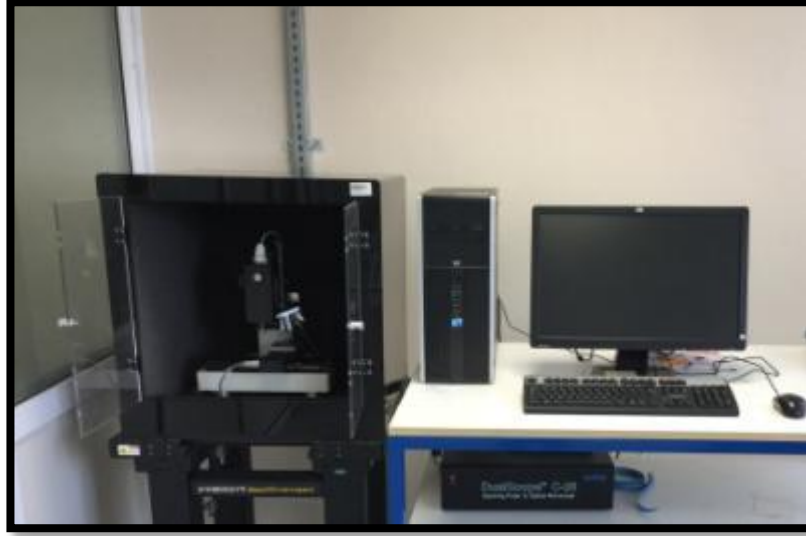
Resim 3-11: Nano indentasyon test cihazı (DME Tools DS 95-90, IBIS, Herlev, Danimarka)
