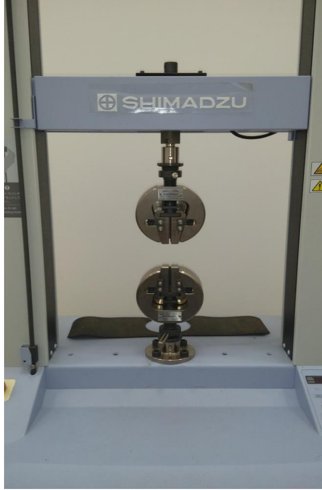
Şekil 2.11 : Shimadzu AG-IC üniversal test cihazı
