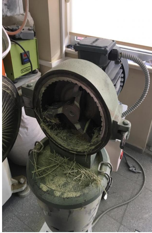
Şekil 2.2 : Mertest LB160 Laboratuvar Tipi Bıçaklı Öğütücü
