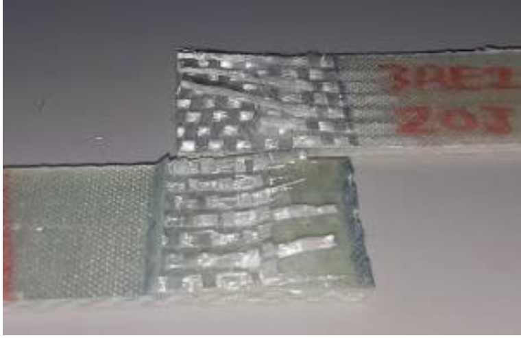
Şekil 5.59: Eksenel darbe sonrası hasara uğrayan numune görüntüsü.
