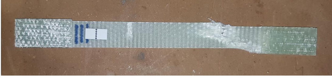
Şekil 4.12: Çekme testi sonrasında hasar gören numune.
