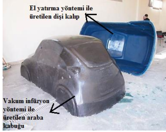
Şekil 2.5: Vakum infüzyon yöntemi uygulaması.
