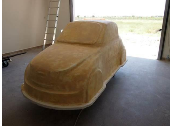
Şekil 2.4: El yatırma yönteminde kullanılan erkek kalıp.
