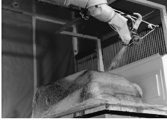
Şekil 2.6: Püskürtme yöntemi ile küvet üretimi [3].
