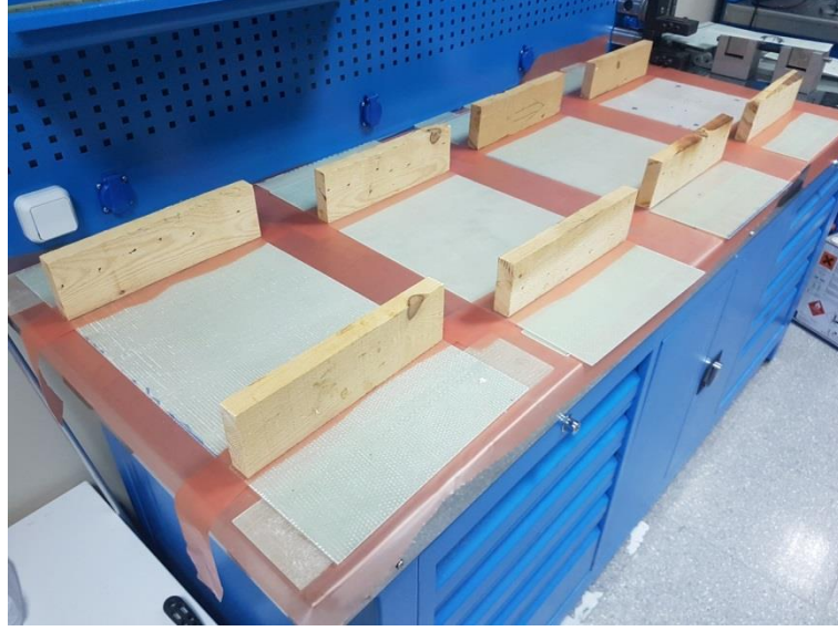
Şekil 4.9: Plakaların tek taraftan yapıştırılması esnasındaki k rlenmeleri.
