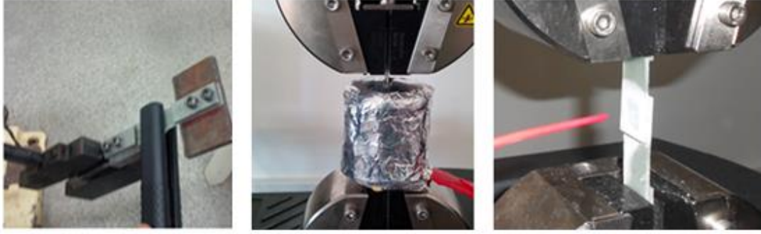
Şekil 5.8: Aksenal darbe ve çekme testleri esnasında ısıtma ve soğutma işlemleri
