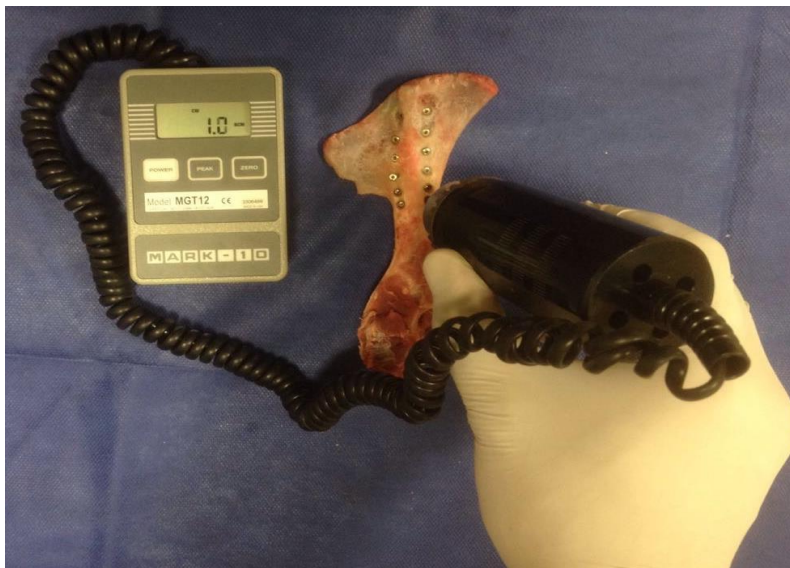
Resim 17: İliak kemiğindeki implantlarda GÇT testi yapılması
