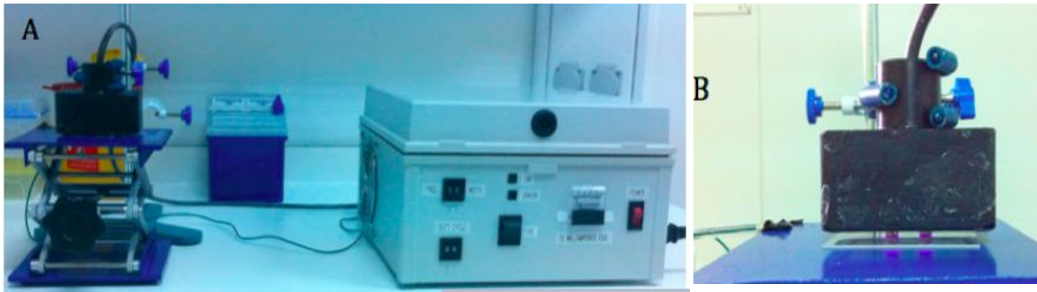
Resim 6. A; Atmosferik soğuk plazma jeneratörü ve ona bağlı olan yüksekliği ayarlanabilir platform üzerine adapte edilmiş plazma uygulama ucu. B; elektrik kaynağına bağlı olan dışı silikon kaplı, içinde bakır plaka olan plazma ucunun yakından görünümü.
