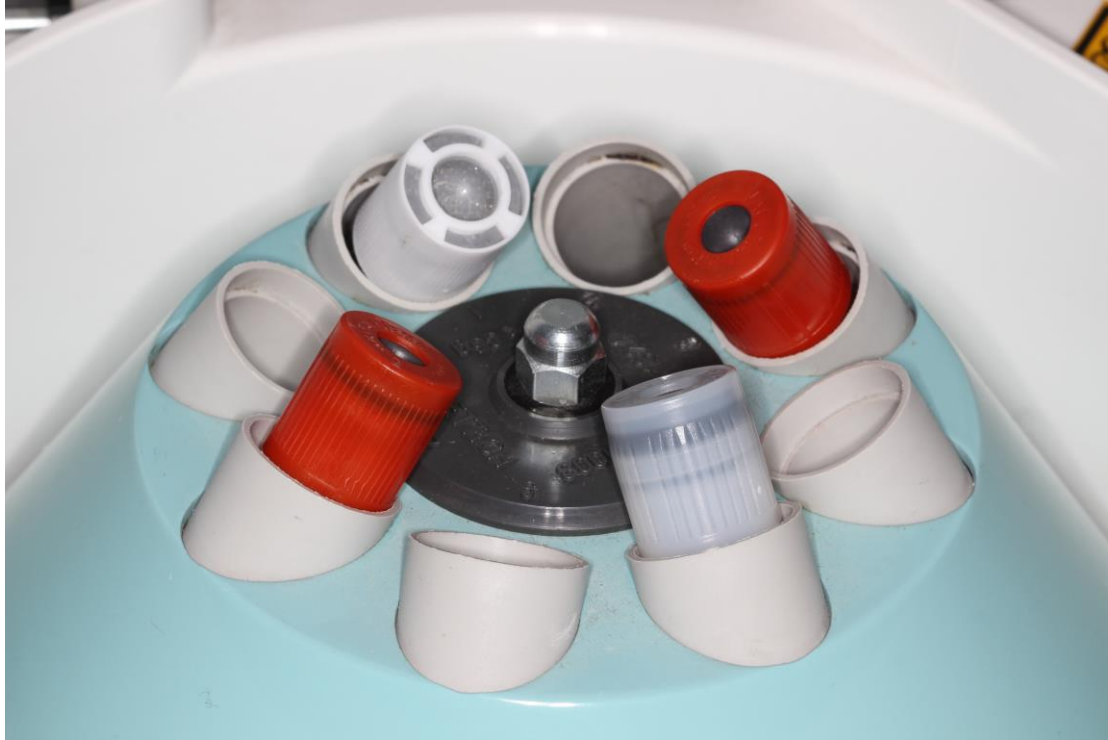
Resim 3: Santrifüj cihazına tüplerin simetrik şekilde yerleştirilmesi
