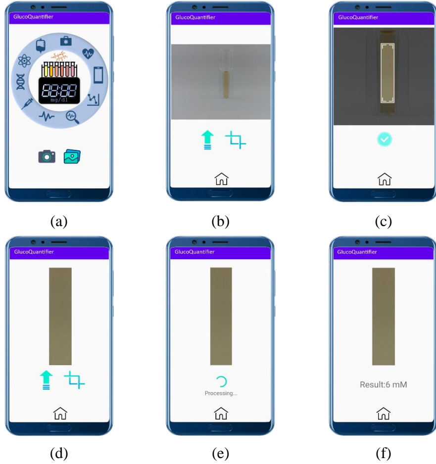
Şekil 4.5: GlucoQuantifier ile kolorimetrik glikoz konsantrasyonu ölçümü adımları. Kullanıcı (a)'da gösterildiği gibi galeriden yada akıllı telefon kamerasını kullanarak görüntüyü seçer ve (b)'deki gibi ekranda görüntülenir. Ayarlanabilir kırpma kutusu (c)'de ve (d)'de verilen ROI'yi çıkarmak için kullanılır. ROI, (e)'de glikoz ölçümü için uzak sunucuya yüklenir ve sonuç (f)'de görüntülenir.
