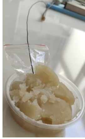
Şekil 4. 4: Antenin Doku Taklit Jeli İçerisine Yerleştirilmesi
