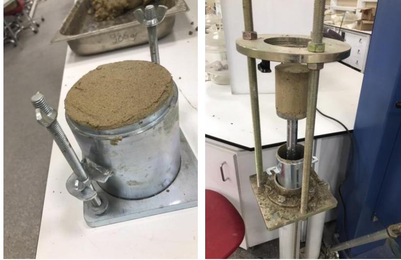
Şekil 3.10a: Standart proctor deneyi numune hazırlama aşamaları 1
