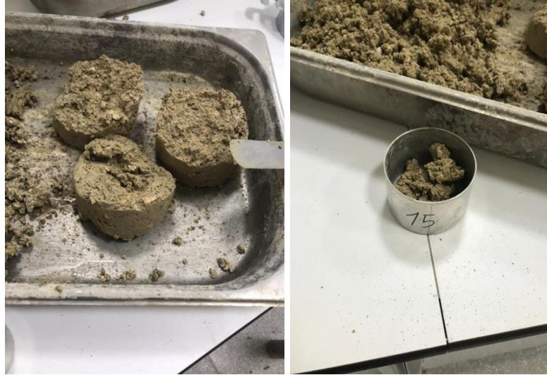
Şekil 3.10b: Standart proctor deneyi numune hazırlama aşamaları 2
