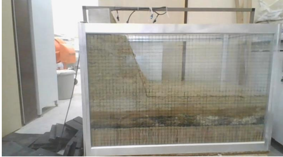
Şekil 6.1: No 10 numaralı deneyin laboratuvar ortamında göçme durumu
