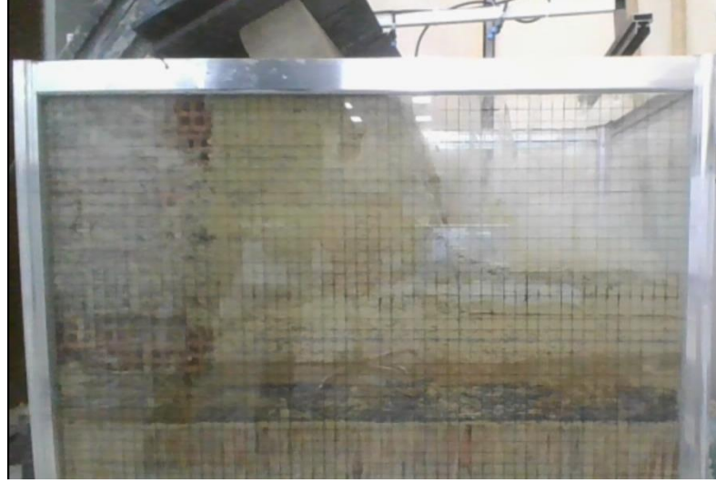
Şekil 6.2: No 12 numaralı deneyin laboratuvar ortamında göçme durumu
