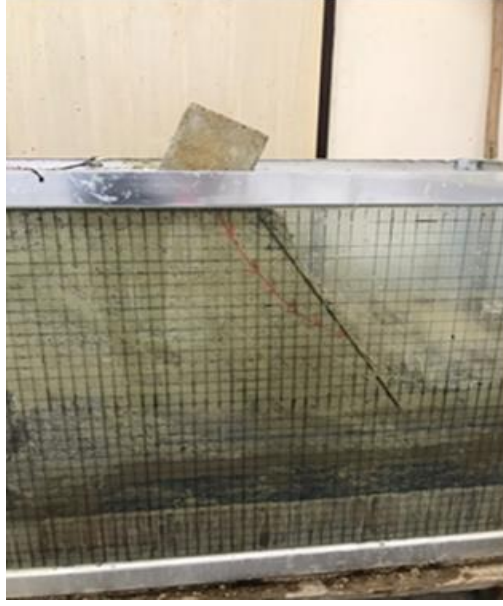
Şekil 6.5: No 15 numaralı deneyin laboratuvar ortamında göçme durumu
