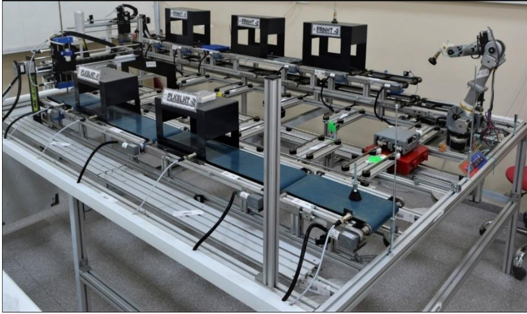
Şekil 5.4: Model fabrika raylı akıllı taşıma sistemi
