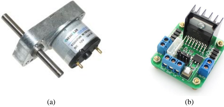
Şekil 4.22: Akıllı taşıma vagonu ana bileşenleri (a) Redüktörlü DC motor, (b) L298N voltaj regülatörlü motor sürücü kartı
