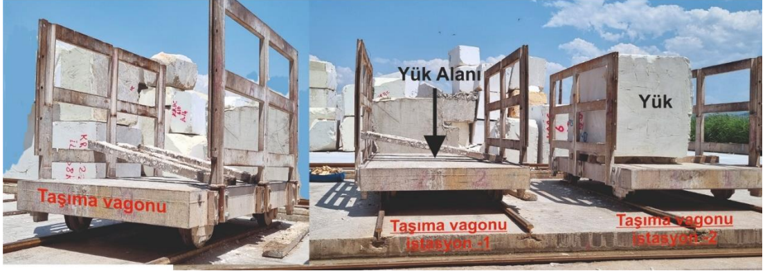
Şekil 5.11: Taşıma vagonu yüklü ve yüksüz görüntüleri
