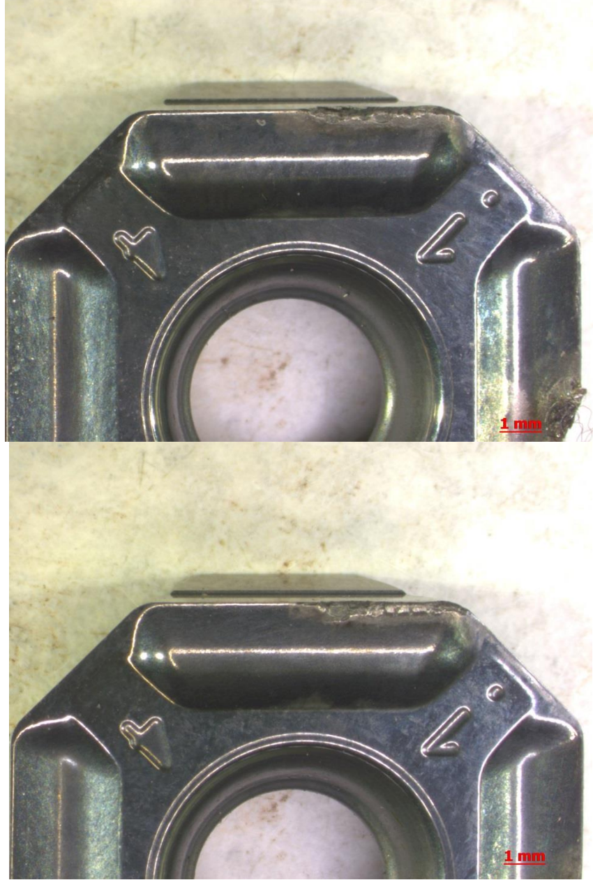
Şekil 3.15: Desensiz kesici ucun V_c=65 m/dk' da işleme yapan kesici uçların yüzeyleri stereo mikroskop görüntüleri, 20X büyütme
