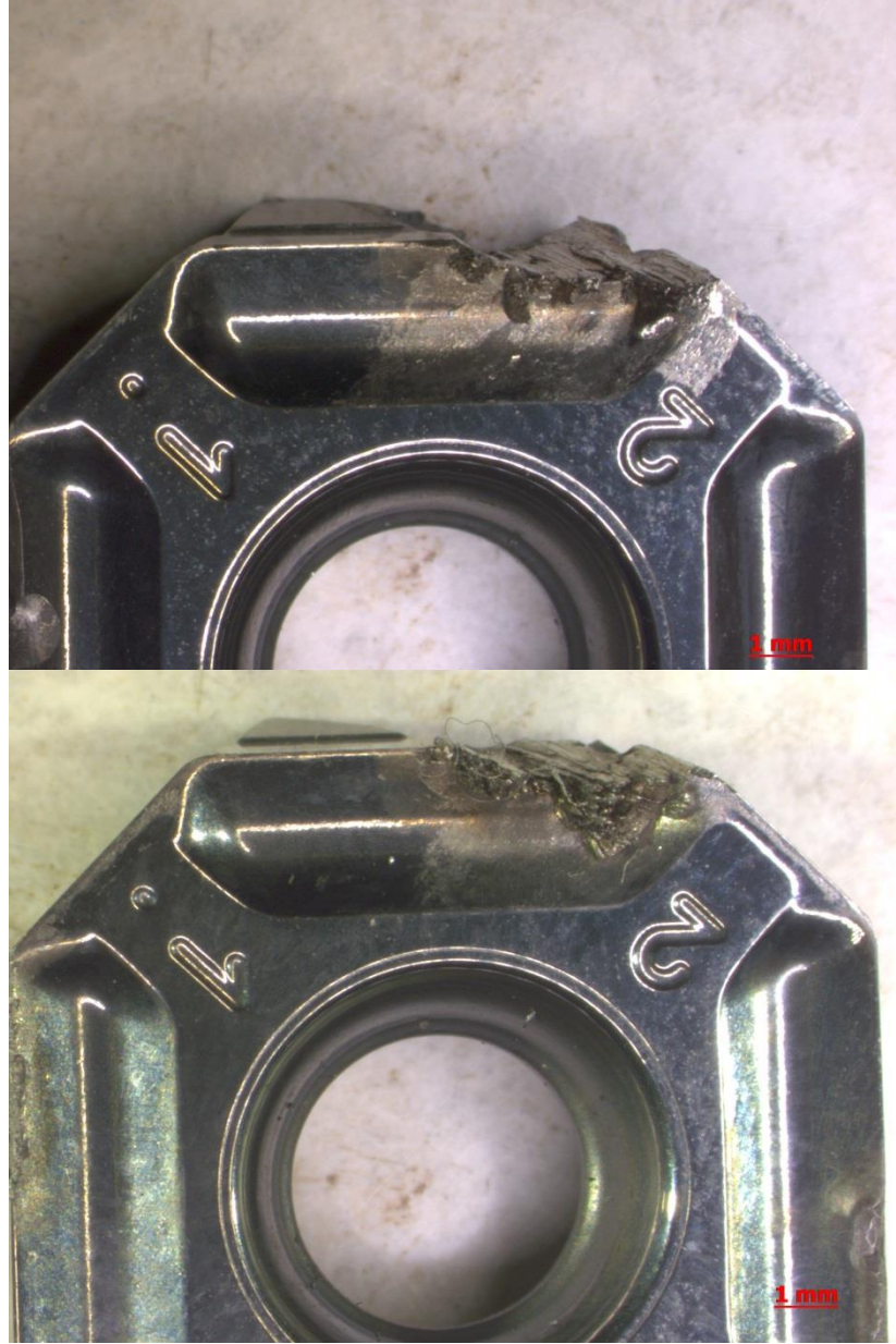
Şekil 3.16: Desensiz kesici ucun V_c=70 m/dk' da işleme yapan kesici uçların yüzeyleri stereo mikroskop görüntüleri, 20X büyütme
