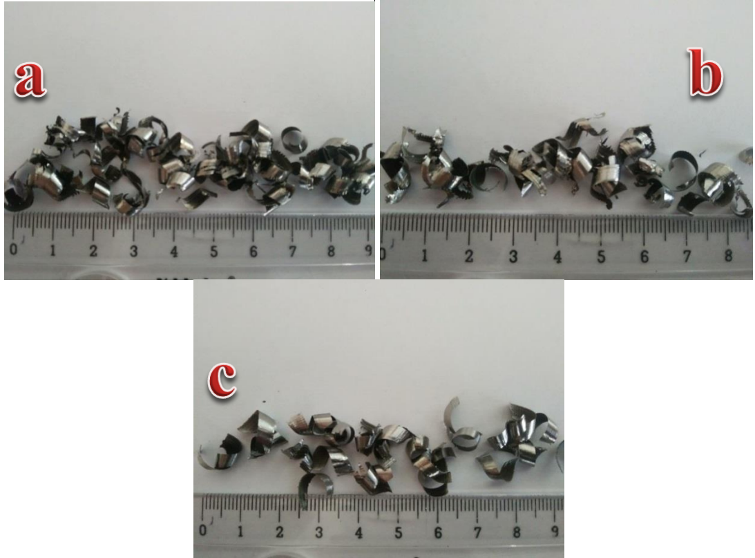
Şekil 3.20: (a) DesenA , (b) DesenB ve (c) Desensiz kesici uçların V_c=75 m/dk için işleme sonrası oluşturduğu talaşlar.
