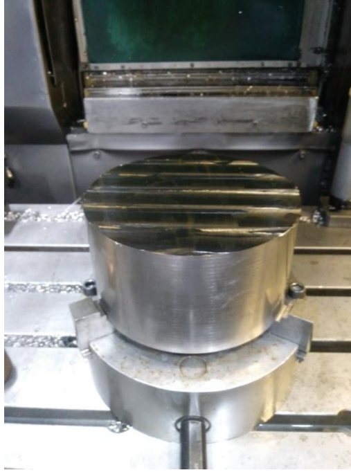
Şekil 2.1: AISI 304L Ø205 mm altlık malzeme
