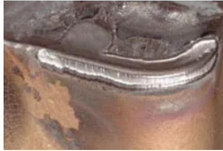
Şekil 1.9: Serbest yüzey aşınması [56]
