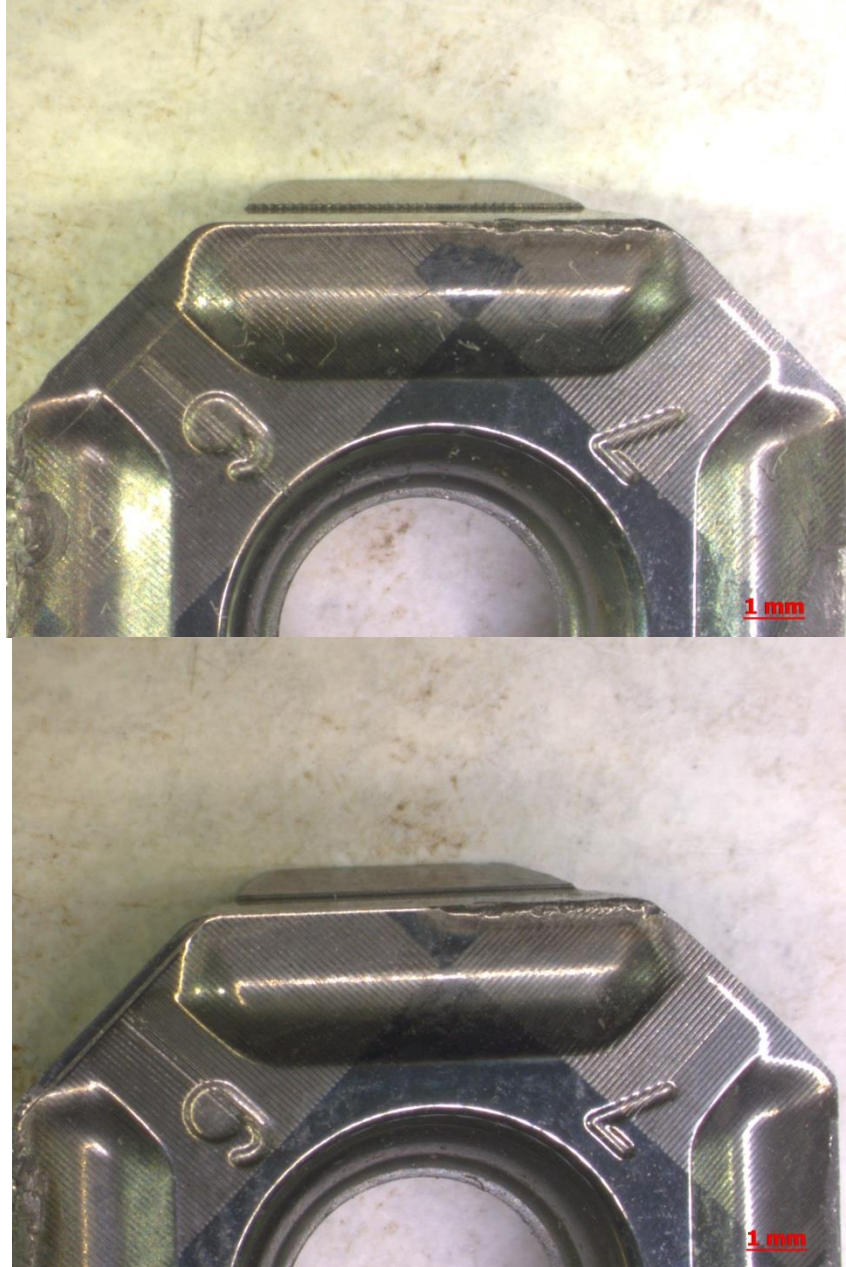
Şekil 3.10: DesenB V_c=65 m/dk' da işleme yapan kesici uçların yüzeyleri stereo mikroskop görüntüleri, 20X büyütme
