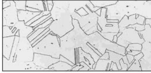
Şekil 1.16: Östenitik paslanmaz çelik mikroyapısı [21].
