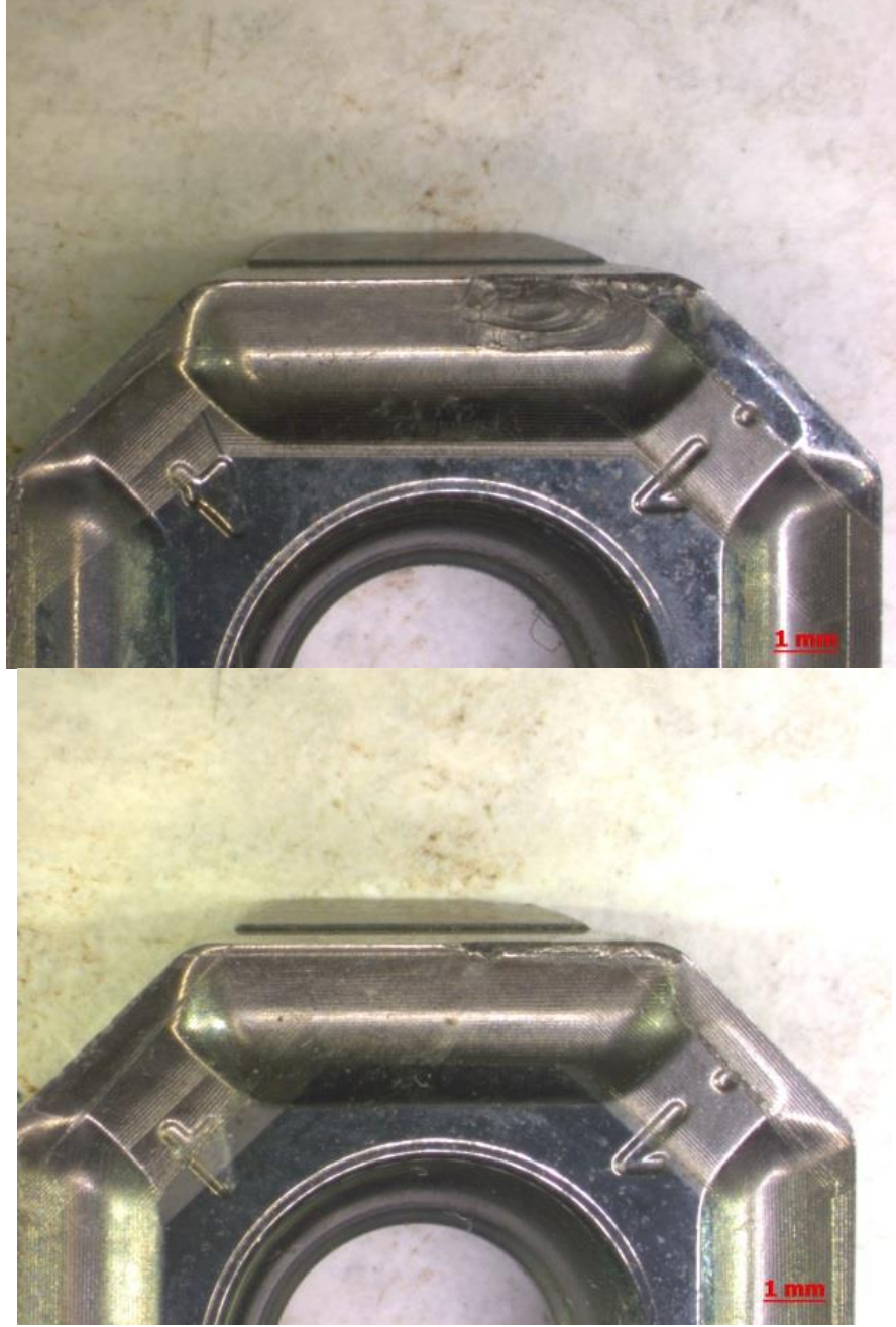
Şekil 3.8: DesenA V_c=75 m/dk' da işleme yapan kesici uçların yüzeyleri stereo mikroskop görüntüleri, 20X büyütme
