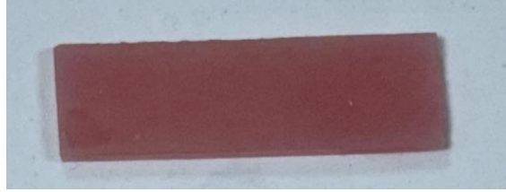
Şekil 3.11. Nanopartikül Katkılanmamış Kontrol Grubu Akrilik Örnek.
