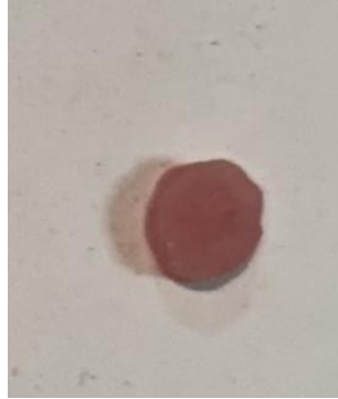
Şekil 3.16. Nanopartikül Katkılanmamış Kontrol Grubu Akrilik Örnek.
