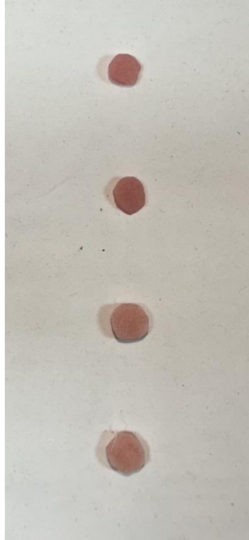
Şekil 3.18. MgO nanopartikülü Katkılanmış Akrilik Örnekler (Yukarıdan Aşağı Sırasıyla % 0,5-1-3-5).
