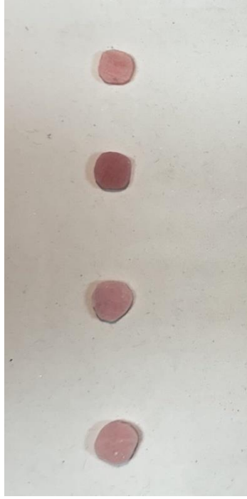
Şekil 3.17. ZnO Nanopartikülü Katkılanmış Akrilik Örnekler (Yukarıdan Aşağı Sırasıyla % 0,5-1-3-5).
