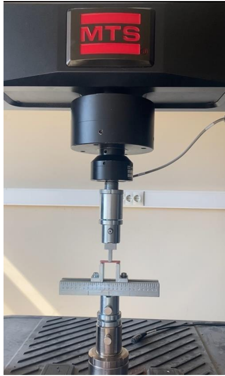
Şekil 3.15. Bir Numuneye Ait Üç Nokta Eğme Testinin Yapılışı.
