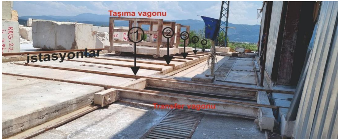
Şekil 5.22: Gerçek bir mermer fabrikasındaki taşıma/transfer vagonları ve istasyonlar
